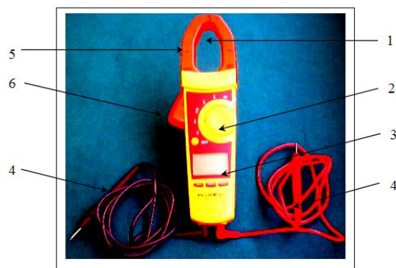
Figura 5.1 Instrumento utilizado para medir amperajes y voltajes
