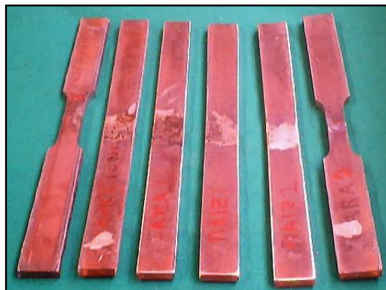
Figura N° 5.3 Dimensiones de la probeta de tracción de sección reducida
