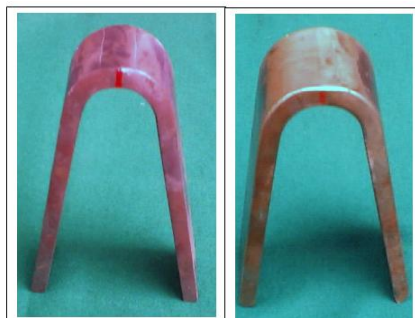
Figura N° 5.10 Probetas de doblado de cara y doblado de raíz luego del ensayo
