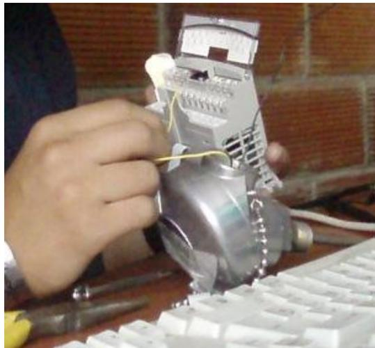
**Figura 4.6** Fotografía del empalme de cables del RTD - Modulo
