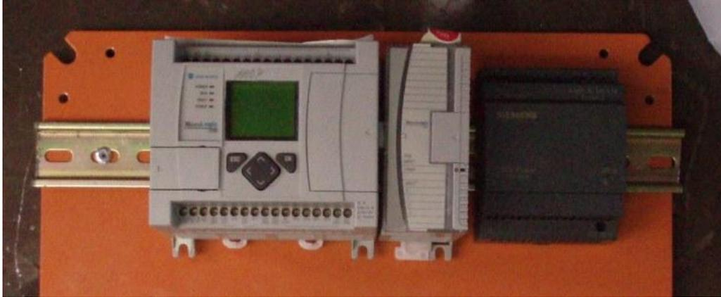
**Figura 4.27** Sistema de control montado en riel DIN
