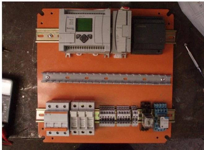
**Figura 4.28** Disposición de elementos en el tablero de control
