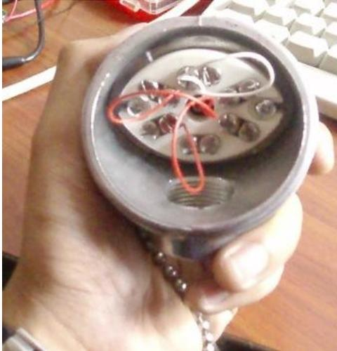
**Figura 4.5** Fotografía de disposición de cables en un RTD
