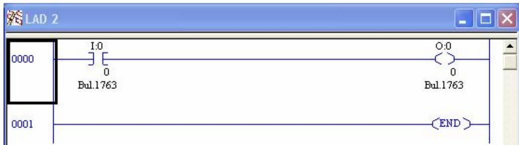
**Figura 4.15** Programa de prueba para luz piloto
