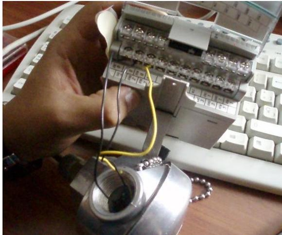
**Figura 4.7** RTD conectado al modulo de expansión
