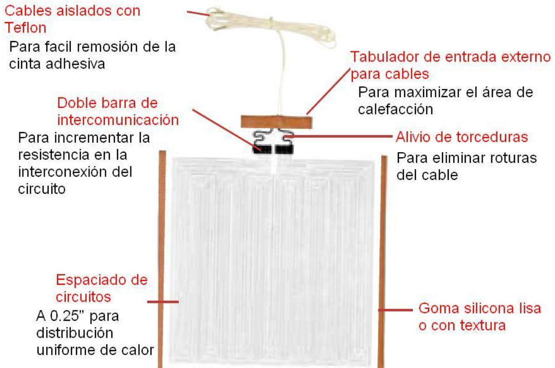
Figura 4.5a. Descripción del Heat Blanket.
