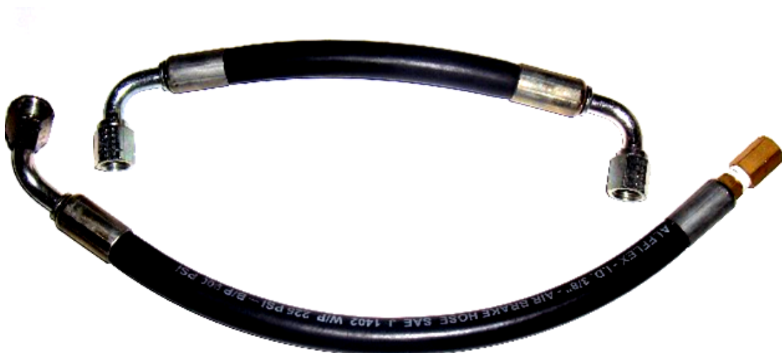
Figura 3.19. Mangueras del Sistema neumático.
