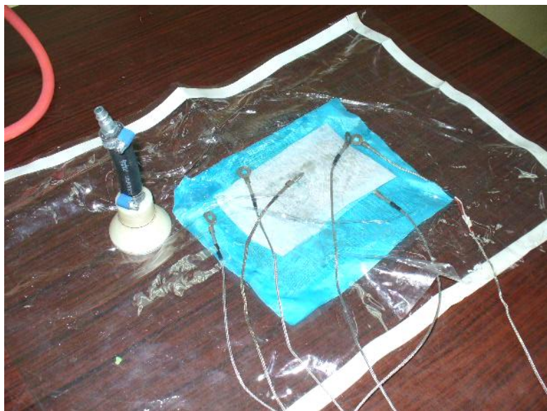
Figura 4.14. Ubicación de las termocuplas antes del proceso de reparación.
