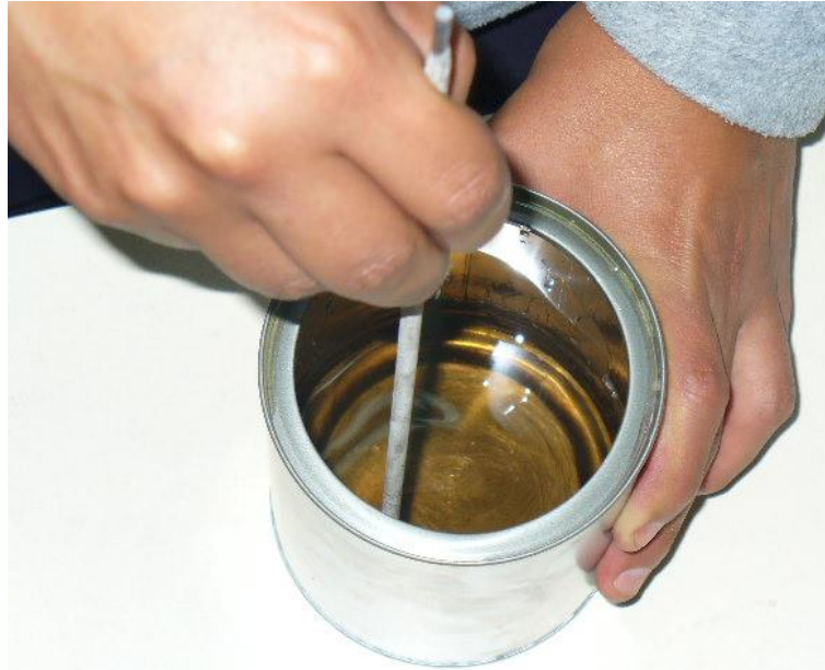
Figura 4.13. Cambio de coloración producto de la reacción química de resina - catalizador.
