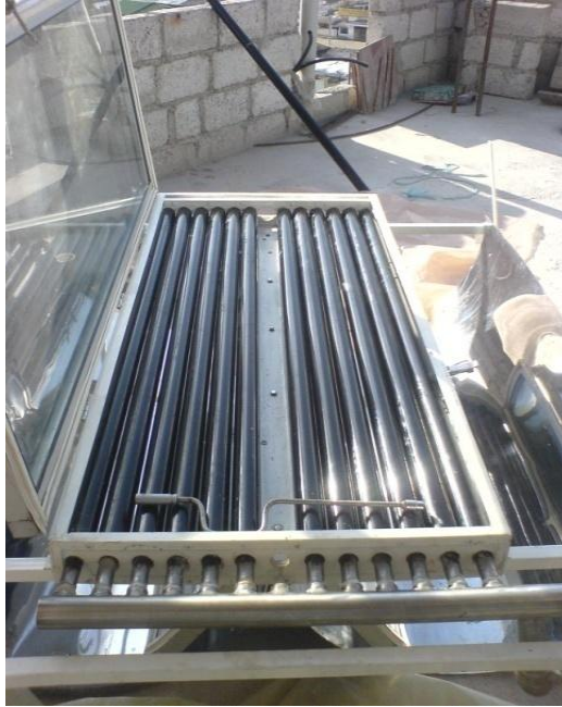
Fotografía 5: Adsorbedor/colector solar armado.
