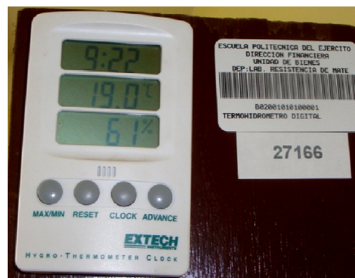
Foto 5-4. Medidor de humedad y temperatura (Laboratorio de Resistencias de Materiales de la ESPE)
