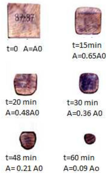
Foto 2-19: Secciones transversales residuales expuestas al fuego.
