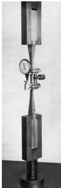
Foto 2-9: Detalle del ensamble para el ensayo de tracción paralela a la fibra (Foto tomada de la norma ASTM D143)
