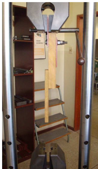
Foto. 5-7. Colocación del espécimen en la máquina de tracción
