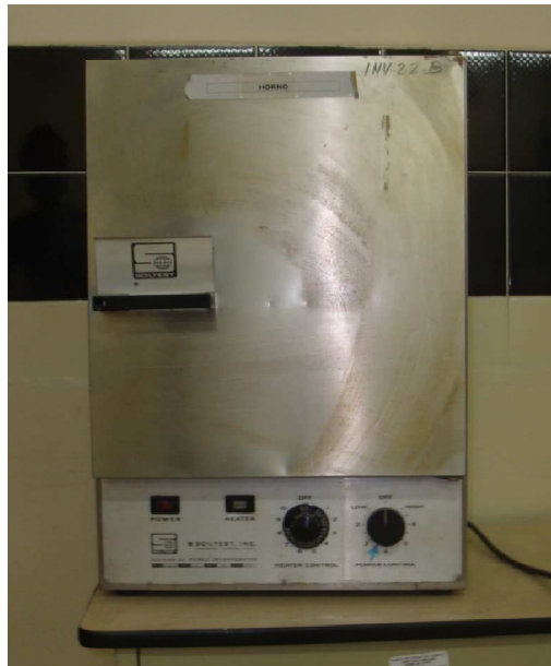
Foto 5-1. Horno de aire forzado del Laboratorio de Suelos, Hormigos y Asfaltos de la ESPE
