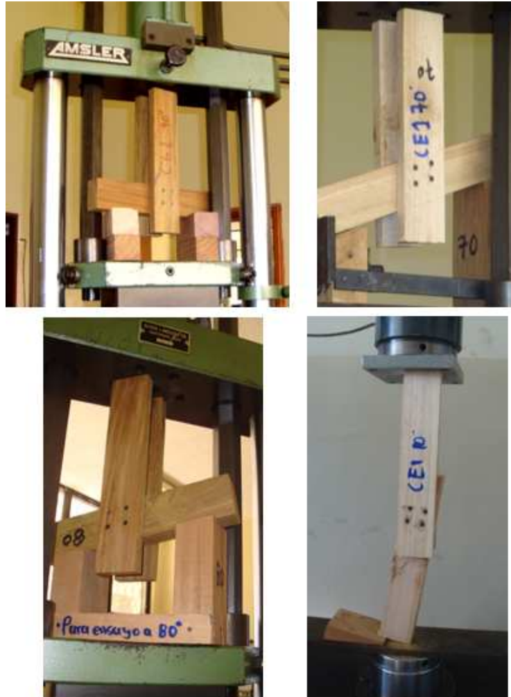
Foto. 5-11 Especímenes a ser ensayados en la máquina de compresión.
