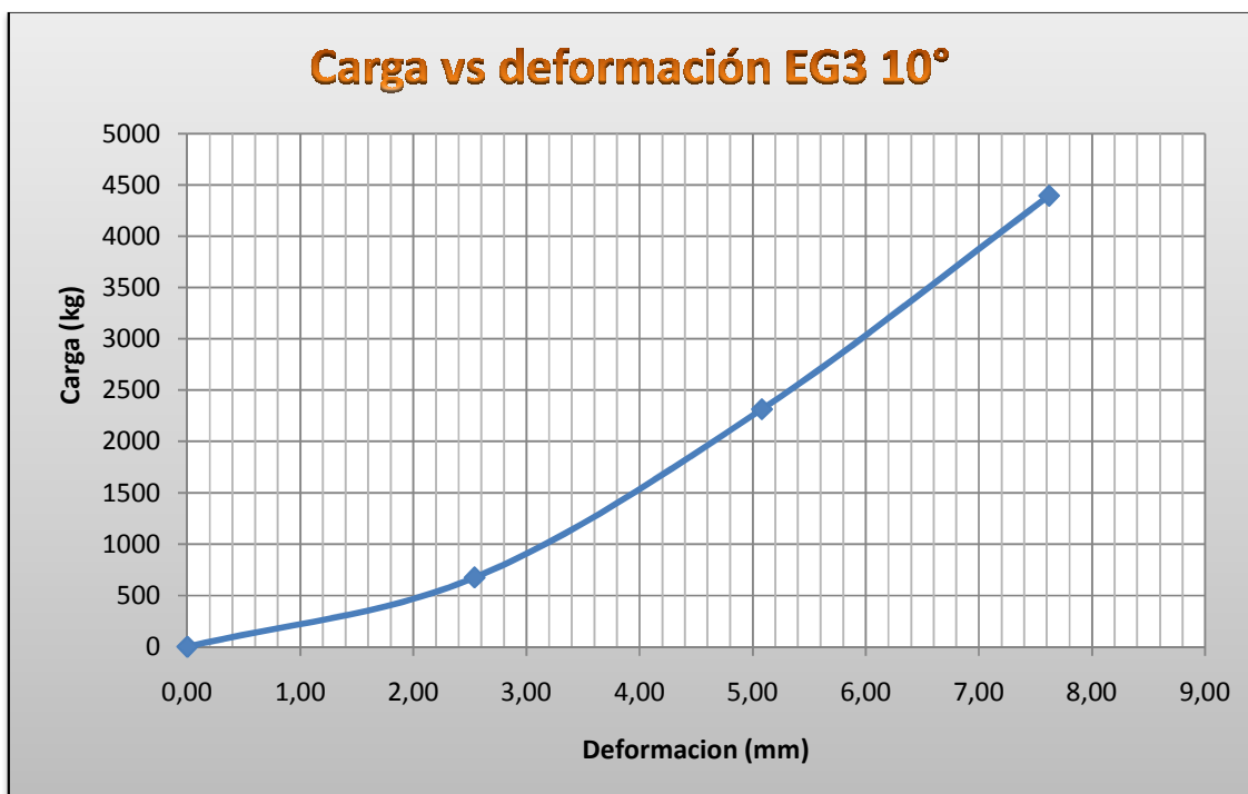
Gráfico 5-12. Curva cargas vs deformación de la muestras 3 de una unión emperrada a 10° de Guayacán
