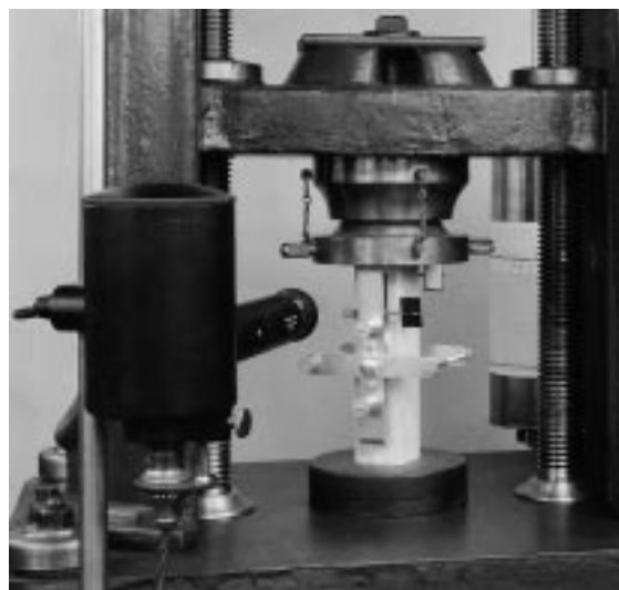
Foto 2-4: Ensamble para la prueba de compresión paralela a la fibra (Foto tomada de la norma ASTM D143)
