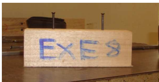
Foto 5-6. Especimen 8 de Eucalipto Globulus para el ensayo de resistencia a la extracción.
