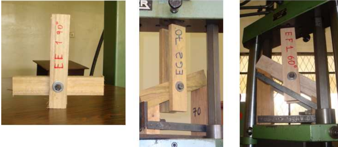
Foto. 5-9. Especímenes a ser ensayados en la máquina de compresión.
