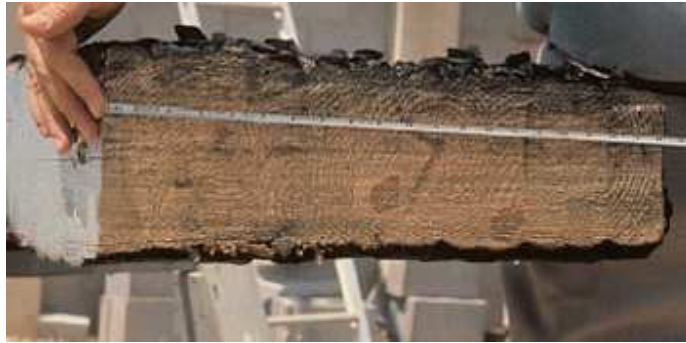
Foto 2-18: Exposición de viga al fuego donde la superficie carbonizada sirve de aislante durante el incendio disminuyendo la velocidad de combustión en el interior.
