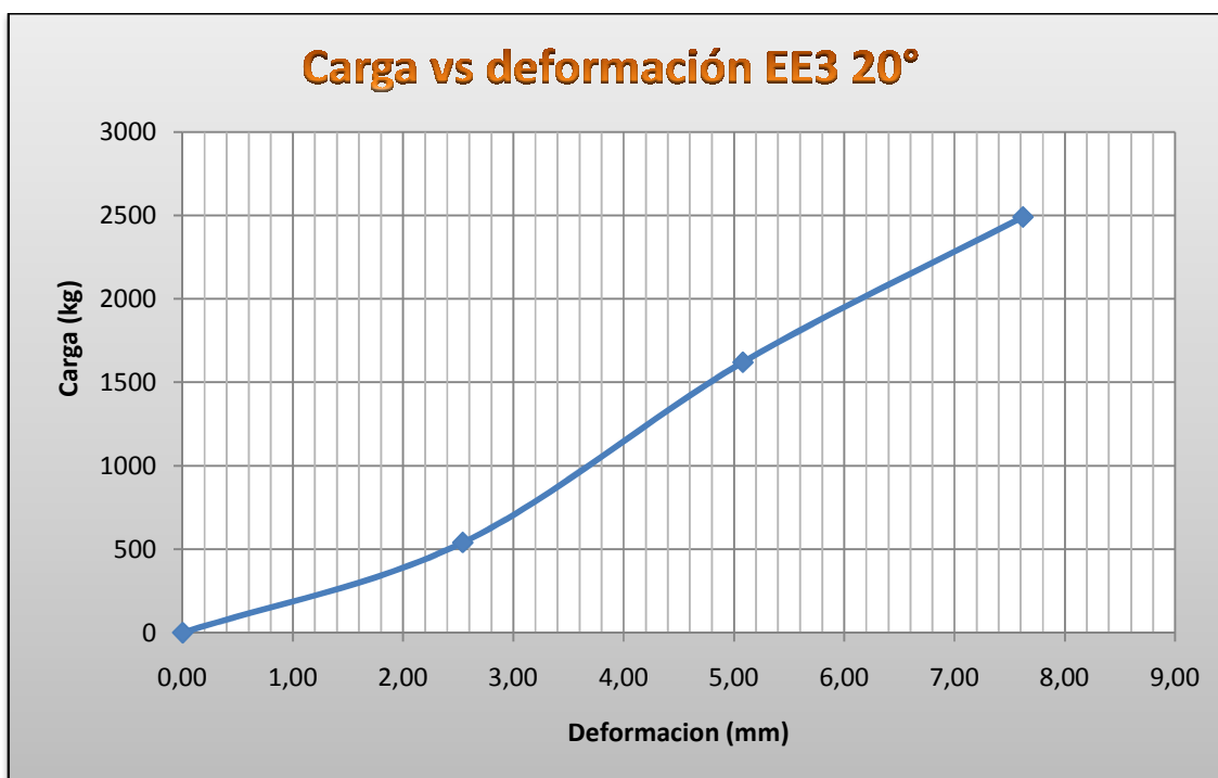
Gráfico 5-21. Curva cargas vs deformación de la muestras 3 de una unión emperrada a 20° de Eucalipto Globulus
