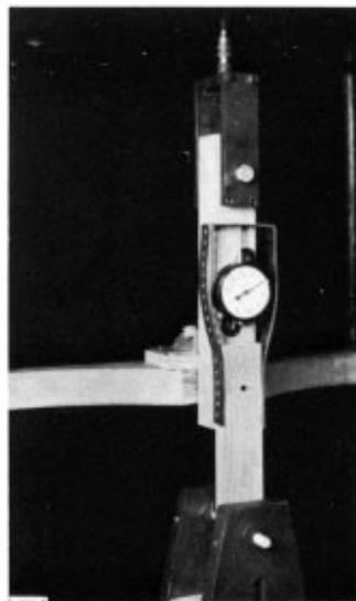
Fig. 2: Ensemble para la prueba de resistencia lateral de clavos, grapas o tornillos
