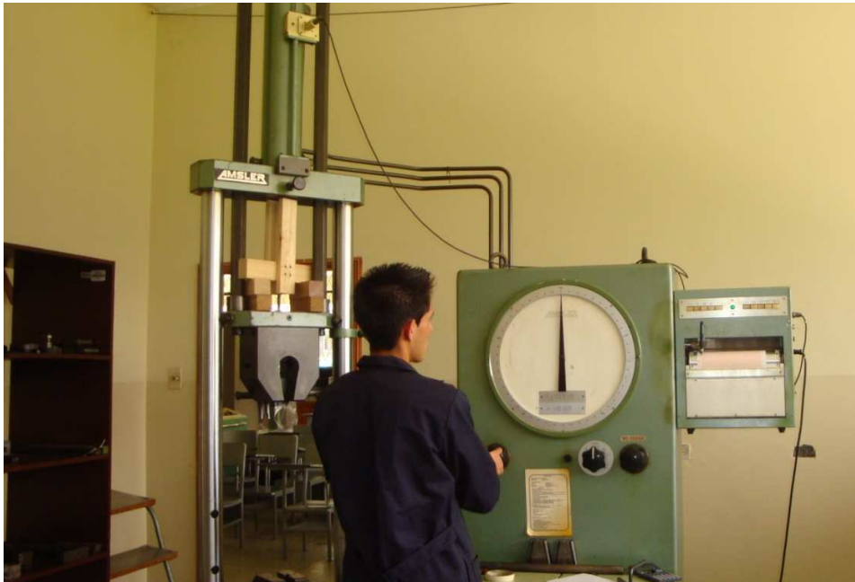
Foto. 5-8. Colocación de un espécimen en la máquina de compresión
