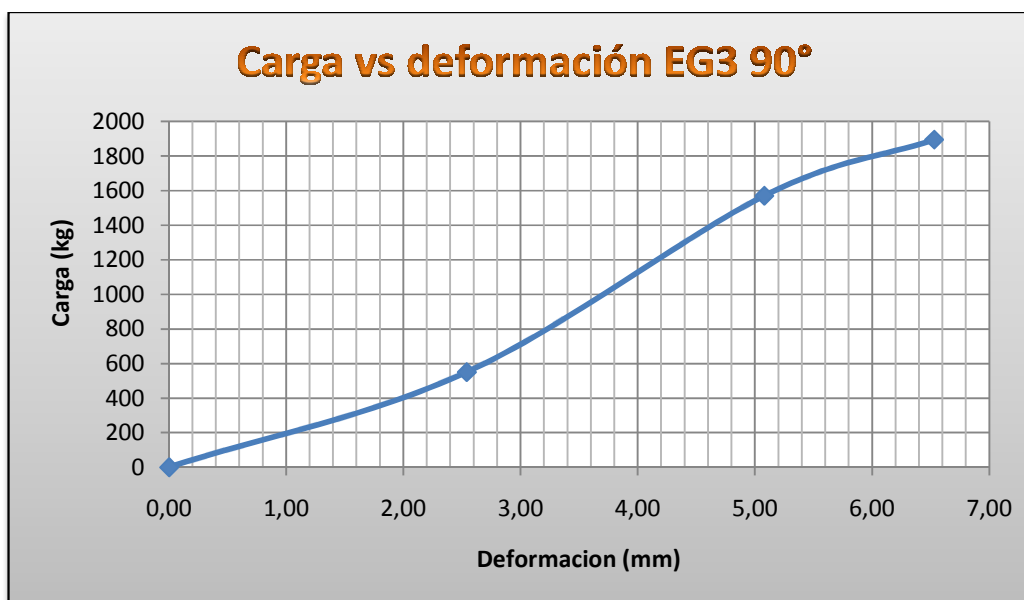
Gráfico 5-4. Curva cargas vs deformación de la muestras 3 de una unión empernada a 90° de Guayacán
