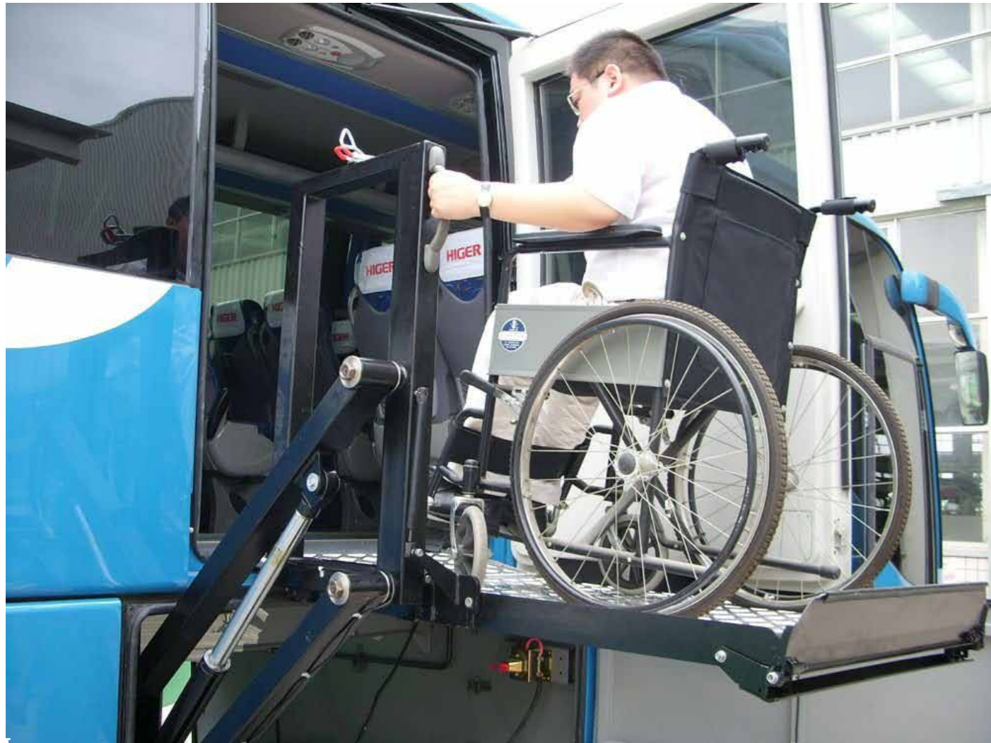
Este elevador de silla de ruedas es un modelo utilizado en China
