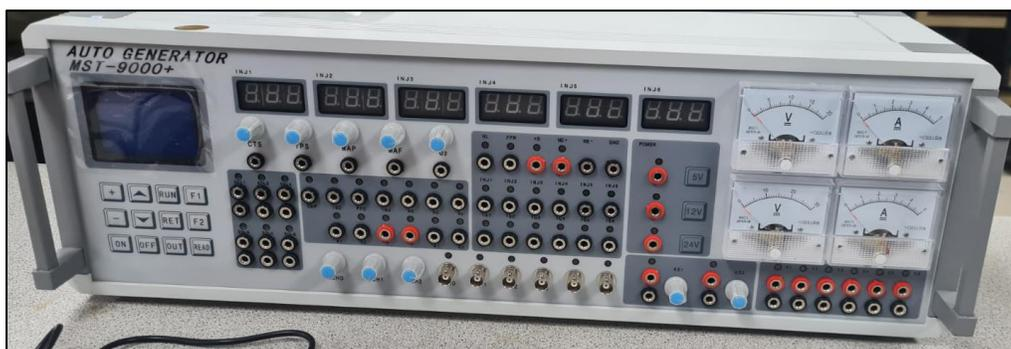
*Nota.* En la figura se puede apreciar el módulo MST - 9000+, el cual se va utilizó para banquear las computadoras.
