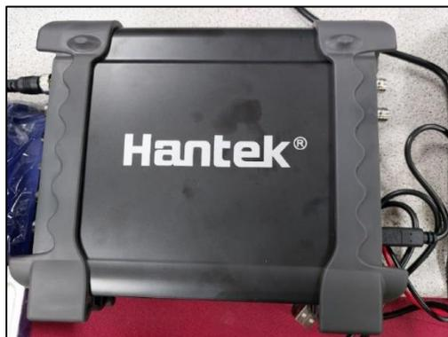
*Nota.* En la figura se puede observar el osciloscopio Hantek 1008C con el cual se obtuvo de manera gráfica las señales y pulsos que envía cada una de las ECUs.
