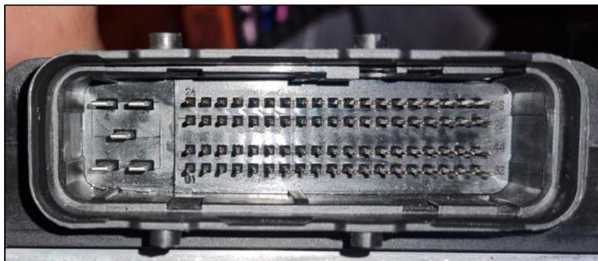
*Nota.* En la figura se puede apreciar el conector de la ECU del vehículo Great Wall Haval M4.
