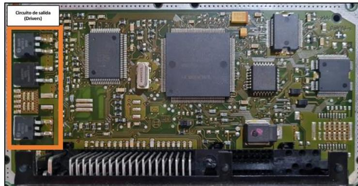
*Nota.* En la figura se puede apreciar señalado dentro del rectángulo lateral izquierdo el circuito de salida, también conocido como drivers.
