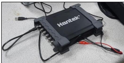
*Nota.* En la figura se puede apreciar el osciloscopio Hantek 1008C.
