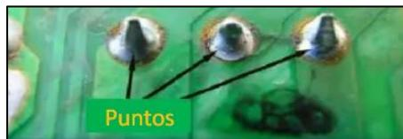
*Nota.* En la figura se muestra las juntas de soldadura agrietadas en la parte posterior de la placa. Tomado de (Guillén, 2018)
