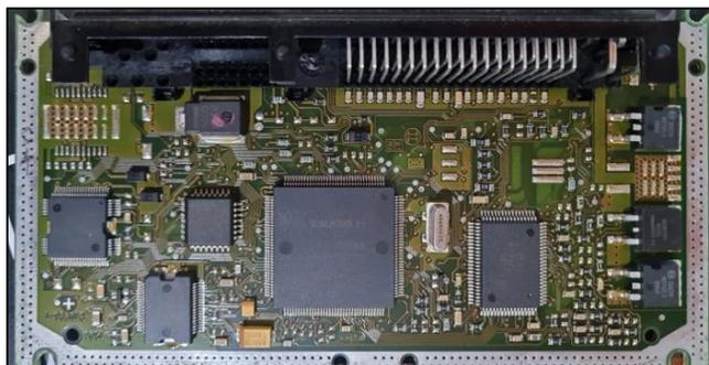
*Nota.* En la figura se puede apreciar el interior de una ECU del vehículo Hyundai Accent 1.5L.
