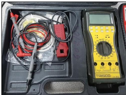
*Nota.* En la figura se puede apreciar el multímetro TRISCO DA - 830 que sirve para realizar distintas mediciones en el sistema electrónico automotriz.
