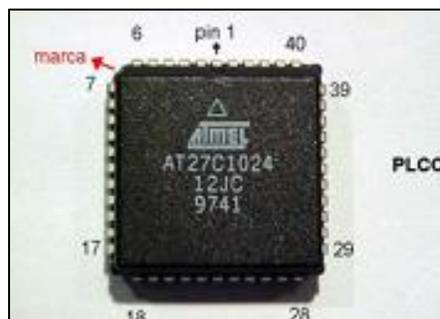
*Nota.* En la figura se puede apreciar la distribución de los pines de una memoria tipo PLCC Tomado de (Grijalva ,2012)
