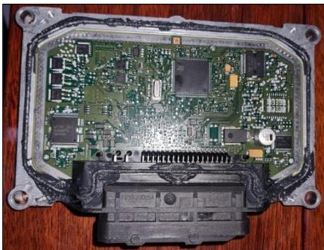
*Nota.* En la figura se puede apreciar el interior de una ECU del vehículo Great Wall Haval M4.
