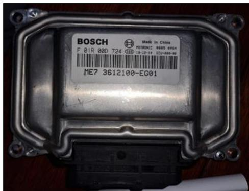
*Nota.* En la figura se puede apreciar el exterior de una ECU del vehículo Great Wall Haval M4.
