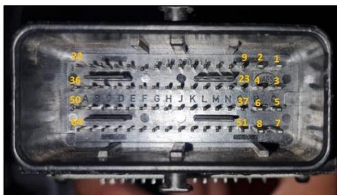
*Nota.* En la figura se puede observar la distribución de los pines en el conector de la ECU Great Wall Haval H5.
