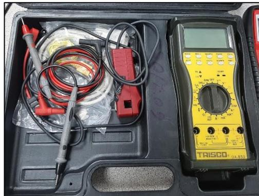
*Nota.* En la figura se puede observar el multímetro TRISCO DA - 830 con el cual se obtendrá los voltajes correspondientes de funcionamiento de los componentes de la ECU.
