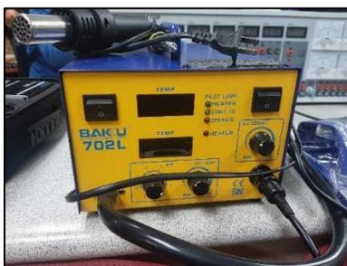
*Nota.* En la figura se puede apreciar la estación de soldadura y pistola de aire que se va a utilizar para la extracción y soldado de los distintos componentes electrónicos.
