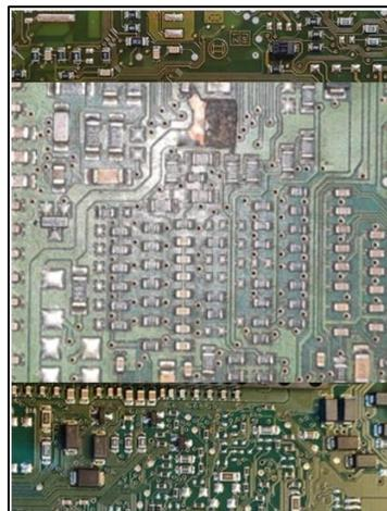
*Nota.* En la figura se puede apreciar los componentes electrónicos que componen el bloque de periferia de las ECUs.
