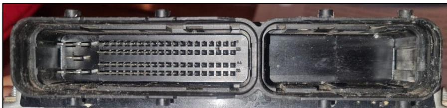
*Nota.* En la figura se puede apreciar el conector de la ECU del vehículo Hyundai Accent 1.5L.
