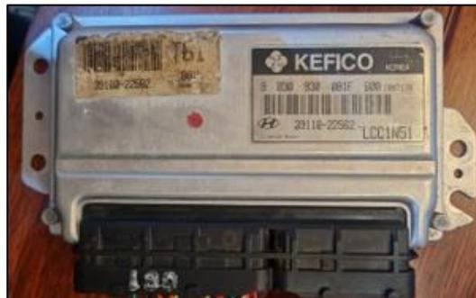
*Nota.* En la figura se puede apreciar el conector de la ECU del vehículo Hyundai Accent 1.5L.
