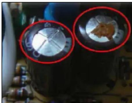
*Nota.* En la figura se observa un par de condensadores en mal estado. Tomado de (Guillén, 2018)
