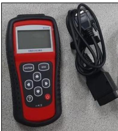
*Nota.* En la figura se puede apreciar el scanner que sirve para realizar distintos diagnósticos.
