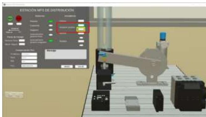
**Prueba de accionamiento de la ventosa.** La ventosa requiere de aire comprimido tanto para succionar como para eyectar la pieza de trabajo, en el primer caso se activa el aire a través del botón "Succión" adhiriendo la pieza a la ventosa y la transporta a la siguiente posición; del mismo modo para soltar la pieza producto de la ausencia de aire se presiona el botón "Soplado", en ambos casos existen dos indicadores de estado que se evidencian en la Figura 71.
