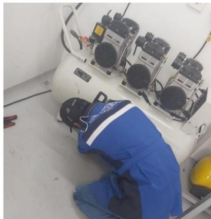
*Nota.* La Imagen muestra la evacuación de los condensados del compresor, manipulando el tapón que se encuentra en la parte inferior del tanque de almacenamiento de aire comprimido.
