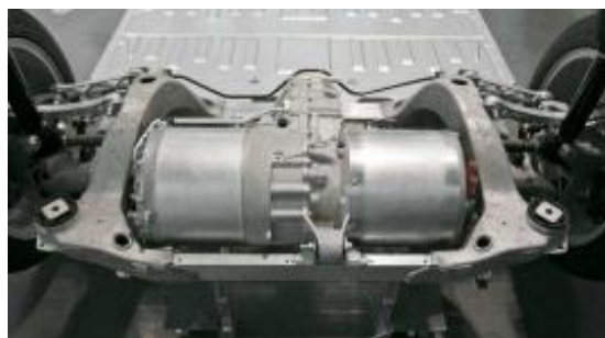
Motor AC Trifásico de un Tesla Modelo S
