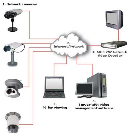
*Nota.* Se observa una red de video vigilancia utilizando un codificador de video permitiendo obtener el video en la red. (Axis Communications, 2019)
