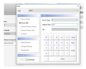
*Nota.* La figura representa la configuración de entradas y salidas del pulsador de la pantalla táctil.
