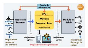
Nota. La figura representa la estructura de un PLC. Tomado de (Sicma21, 2021).
