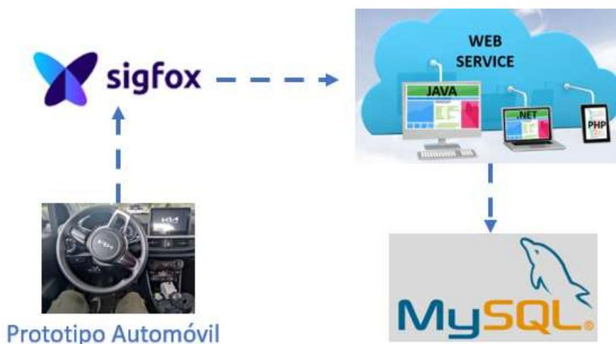
La base de datos se encuentra realizada en php MySQL, para lo cual usamos web service mediante el método GET debido a que nos permite obtener un listado de datos, el mismo que configuramos en el backend de Sigfox como se observa en la Figura 66.
