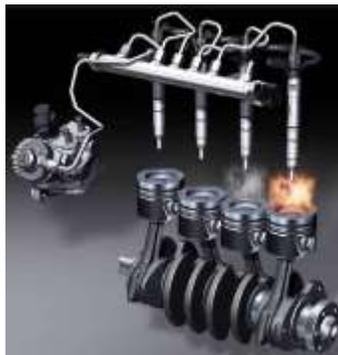
*Nota.* En la Figura 34, se tiene los inyectores por cada uno de los pistones del vehículo. Tomado de Central Recambio Original, 2021.
