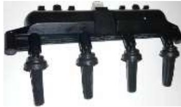
*Nota.* Se muestra en la Figura 35, las bobinas independientes parte fundamental de la generación de la chispa en el encendido del automóvil. Tomado de AutoDaewooSpark, 2022.
