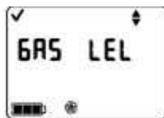
Pantalla de Ajuste del tipo de LEL
