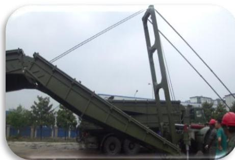
*Nota.* La ilustración del bastidor de elevación con la polea. Tomado de (B.E 68 «COTOPAXI», s. f.).
