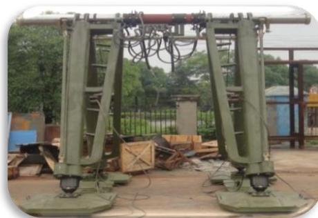
*Nota.* La ilustración de la columna superior de los bípodes del puente. Tomado de (B.E 68 «COTOPAXI», s. f.).
