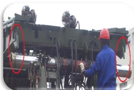
*Nota.* La ilustración del gancho de apoyo sobre el pie de puente. Tomado de (B.E 68 «COTOPAXI», s. f.).
