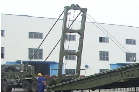
*Nota.* La ilustración podemos evidenciar el Ascensor de Polea Puente HZ Tipo Tijera.
