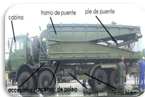
*Nota.* La ilustración de las partes principales del puente mecanizado. Tomado de (B.E 68 «COTOPAXI», s. f.).
