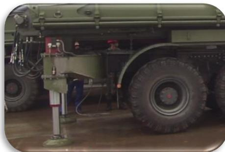
*Nota.* La ilustración de pie de estabilidad y estabilizador de vehículo. Tomado de (B.E 68 «COTOPAXI», s. f.).
