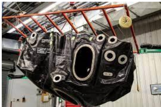
Tanque de Combustible de Caucho Flexible
