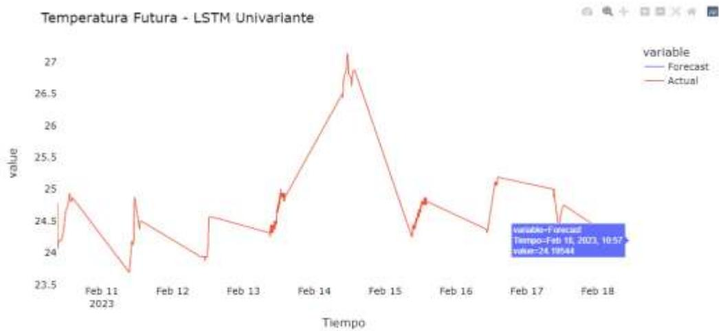
*Nota.* La gráfica muestra los resultados obtenidos de la predicción de la temperatura del agua en comparación con los valores actuales. Fuente: Elaboración Propia.
