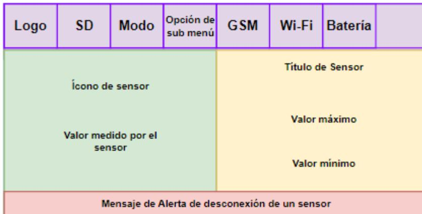
*Nota.* Se muestran las secciones del display de la EMP. Fuente: Elaboración propia.
