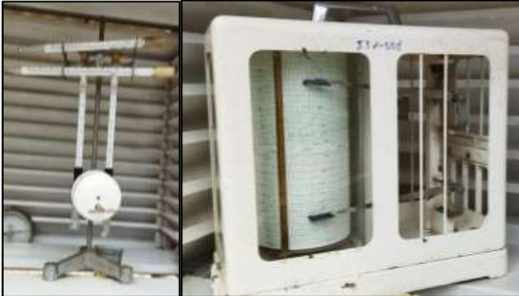
*Nota.* Instrumentos de medición de temperatura y humedad, termo hidrógrafo de “Puerto Ila”. Elaboración propia.
