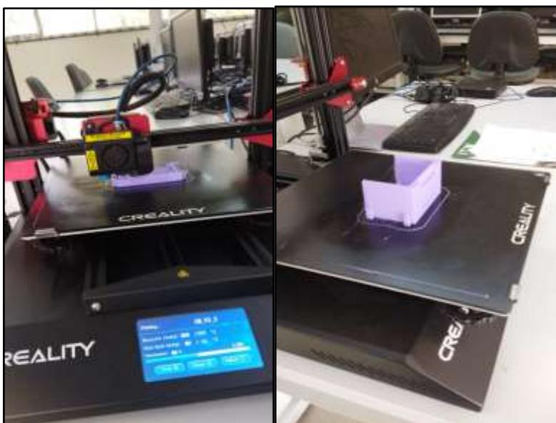
*Nota.* Se observa en la figura el proceso de impresión de la pieza 3D, así como el terminado de la pieza impresa, sobre la impresora 3D de la universidad. Fuente: Elaboración propia.
