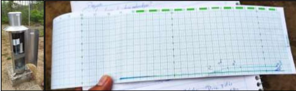
*Nota.* Instrumento de medición de lluvia, pluviógrafo de “Puerto Ila”. Fuente: Elaboración propia.
