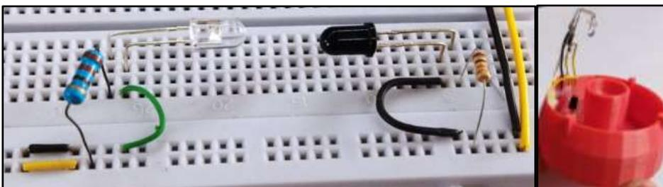
*Nota.* El sensor que se muestra en la figura es el sensor que se ha ocupado en el proyecto para el anemómetro. Fuente: Elaboración propia.
