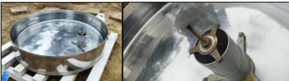
*Nota.* Instrumento de medición de evaporación, tanque de evaporación de “Puerto Ila”. Fuente: Elaboración propia.
