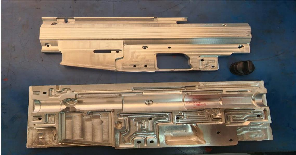
*Nota. Recibidores mecanizados en CNC, vista interna y posterior del arma no-letal*
