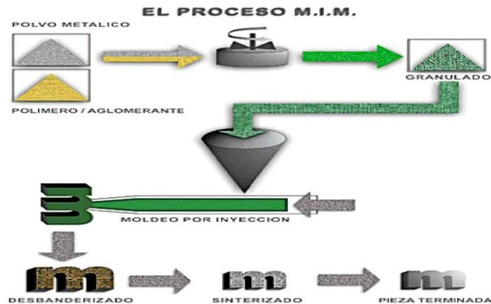
*Nota.* Proceso de moldeo por inyección paso a paso, hasta obtener el producto final. (Ecrimesagroup, 2023) <https://Ecrimesagroup.Com/Es/Como-Usar-La-Tecnica-Mim-de-Moldeado-de-Metales/>.
