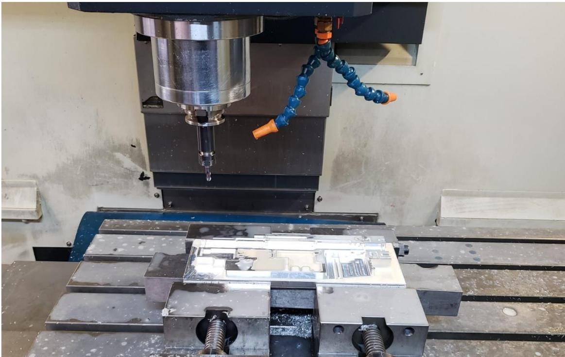
*Nota.* Proceso de mecanizado del receptor derecho en CNC
