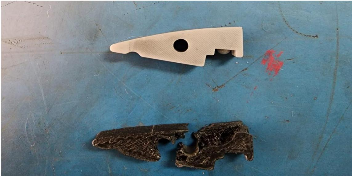
*Nota.* Fiador de resina conjuntamente con fiador de P.L.A, el cual falló en los ensayos de tiro.
