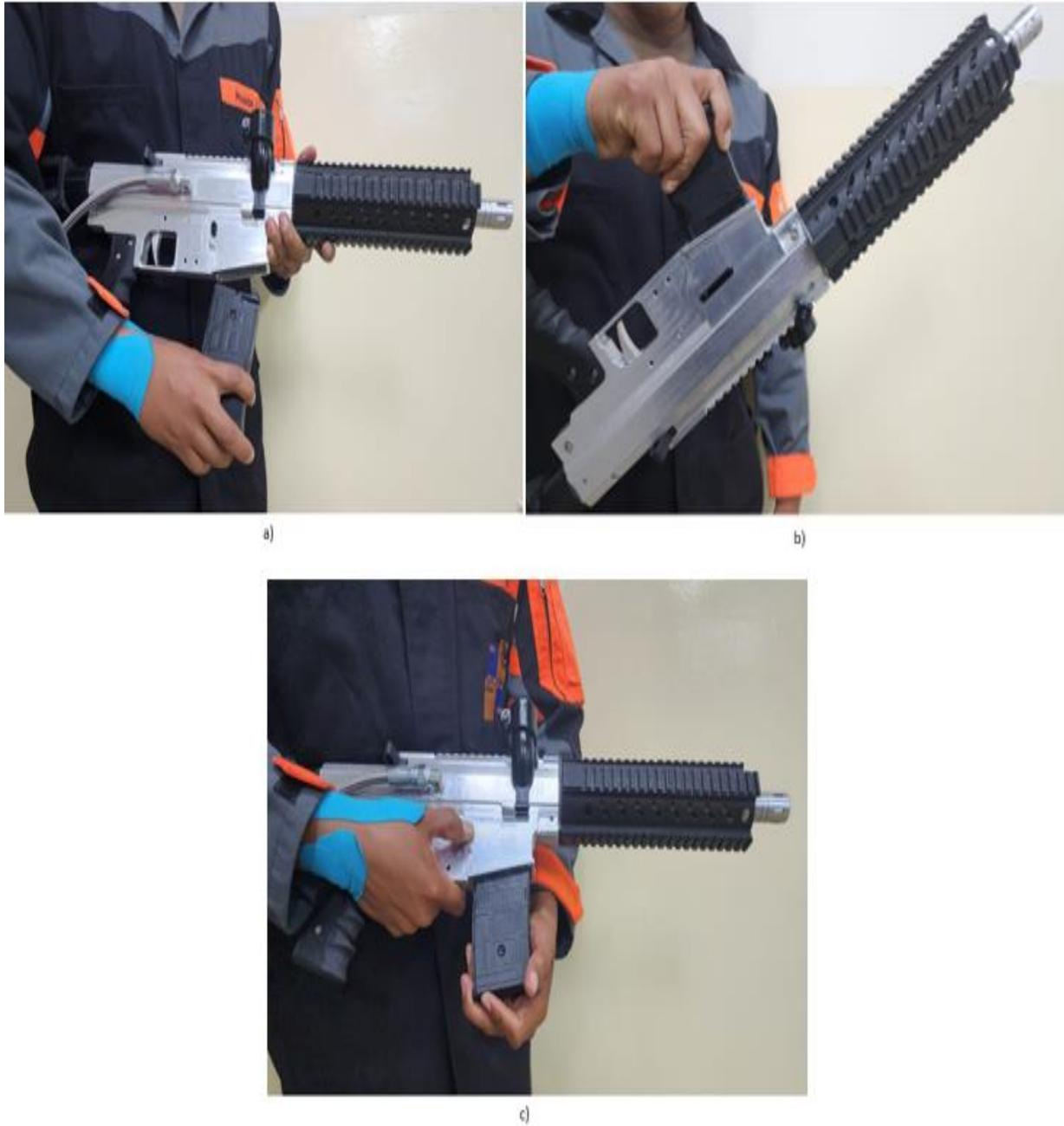
*Nota.* a) Ingreso del cargador falso al cuerpo del arma, b) Verificación de enganche entre el cargador y el pestillo, c) Liberación del cargado a través del pulsador.
