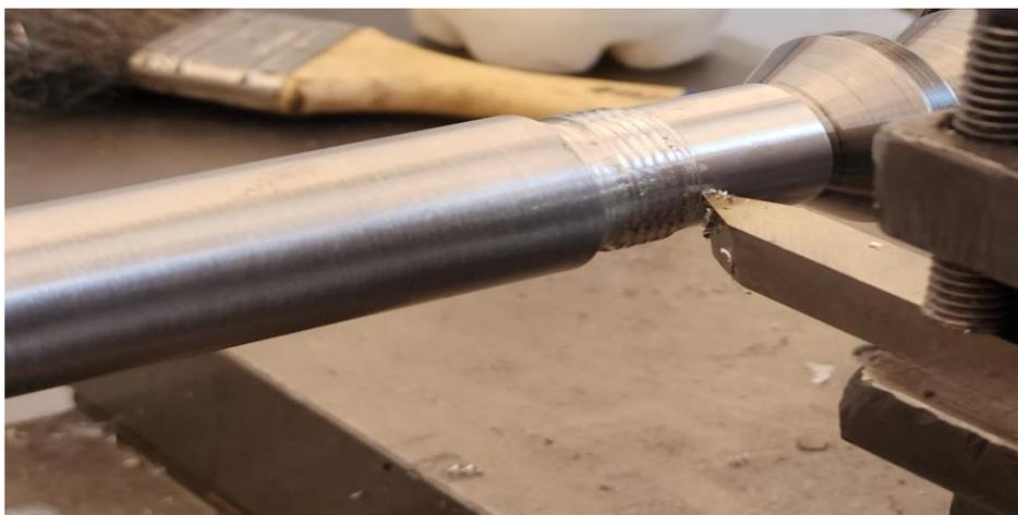
*Nota.* Tubo cañón del arma no-letal en el mecanizado de la rosca.
