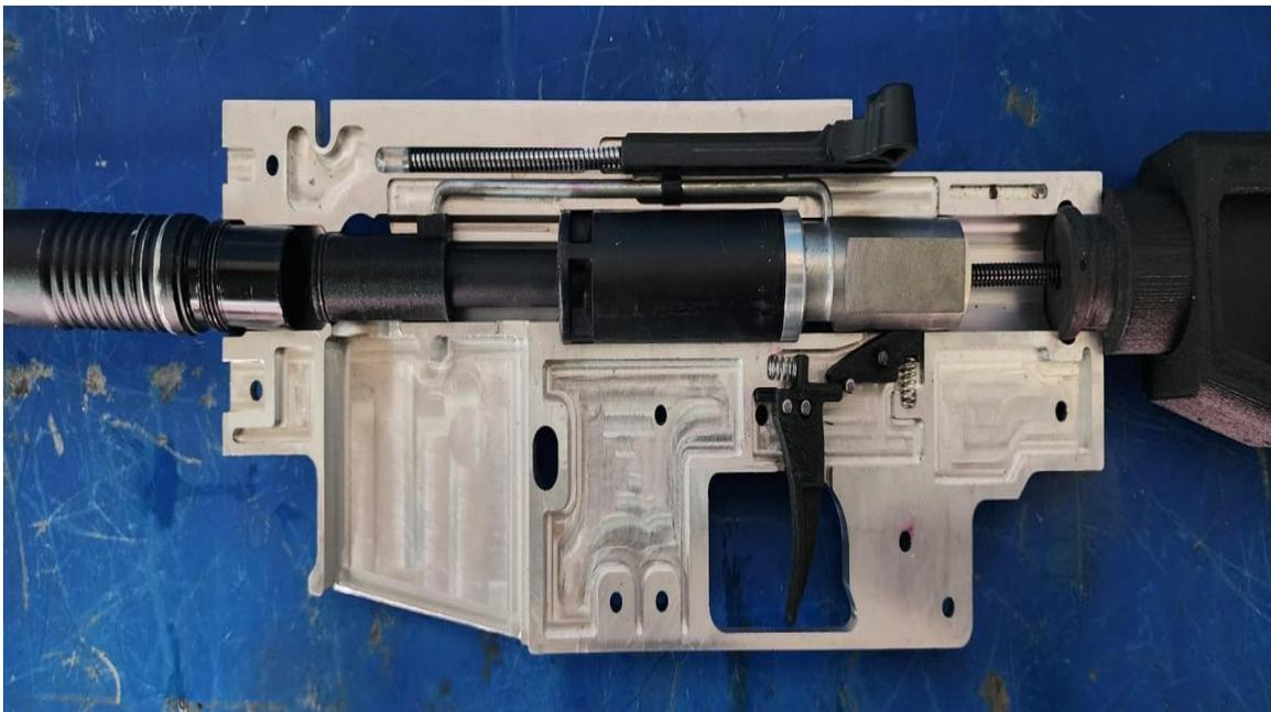
*Nota.* Cuerpo del arma no-lethal con los elementos de propulsión, manija de carga, tubo de potencia, fiador, gatillo disparador, tubo cañón y culata.
