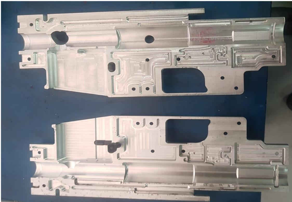
*Nota.* Cuerpo del arma no-letal, sin los elementos de propulsión para verificar la geometría de las piezas.
