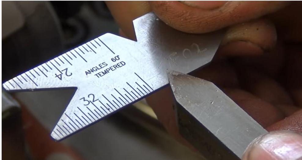
*Nota.* Uso de una galga patrón de 60° para verificar el buril de roscas a ser utilizado para el tubo cañón.
