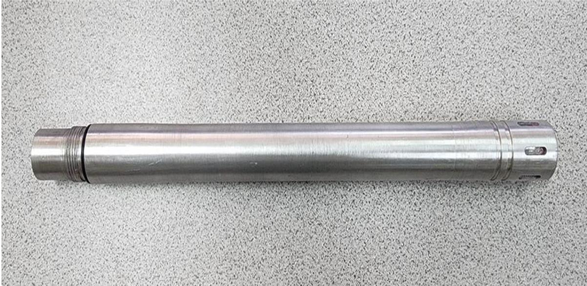
*Nota.* Tubo cañón mecanizado en torno de precisión para arma no-letal.
