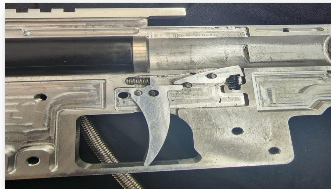
Fiador y rabillo disparador de aluminio reemplazados en el arma no-letal.
