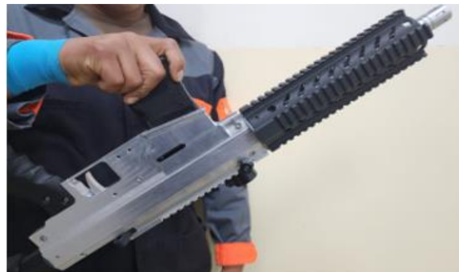
b) Verificación de enganche entre el cargador y el pestillo
