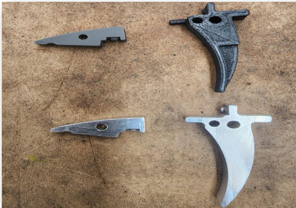
Fiador y rabillo disparador fabricados en aluminio 7075-T6
