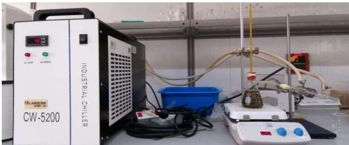
*Nota.* Izquierda: enfriador industrial de agua; derecha: equipo de destilación por arrastre de vapor
