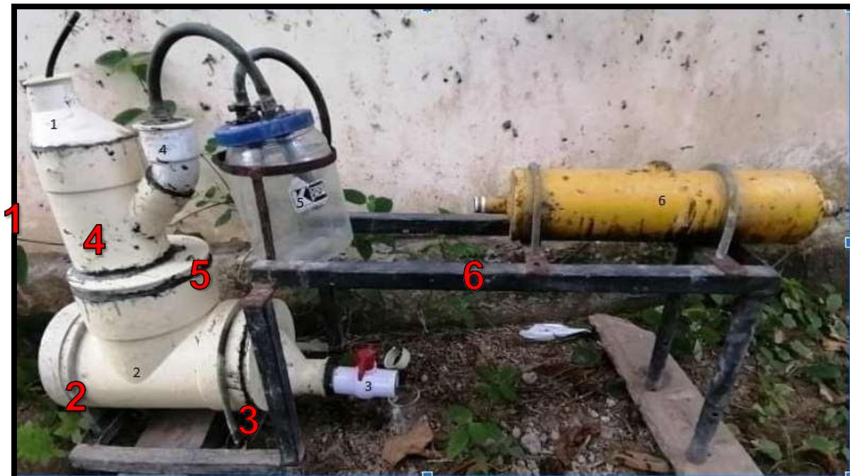
*Nota.* 1. Ducto de alimentación, 2. Tanque de digestión, 3. Válvula de recolección de biol, 4. Ducto de colección para gas, 5. sistema de filtración para biogás, 6. Tanque de colección de biogás.
