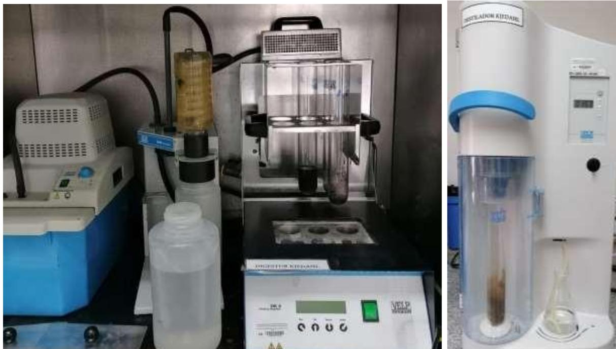
*Nota.* Izquierda: Unidad de digestión Kjeldahl; derecha: unidad de destilación kjeldahl
