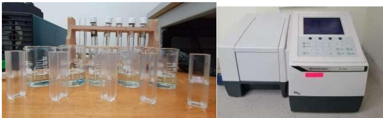
*Nota.* Izquierda: muestras coloreadas para determinación de DQO; derecha: Espectrofotómetro Modelo Shimadzu UV-1280.
