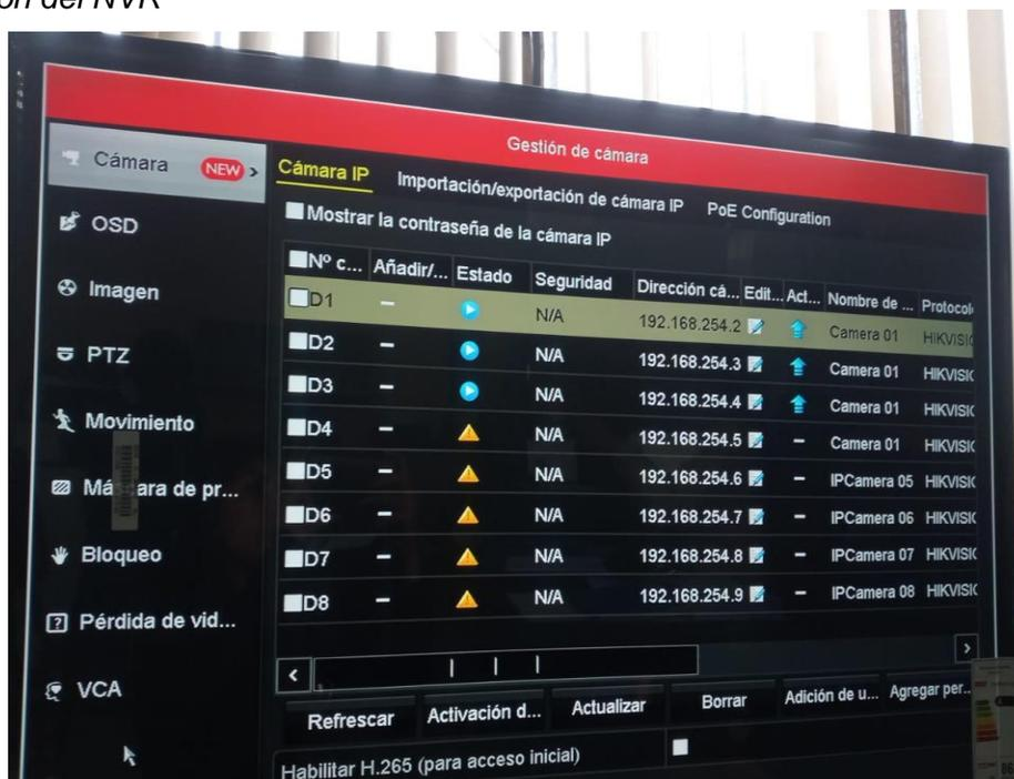
Nota. Configuración del sistema en el NVR de las direcciones ip de cada cámara.
