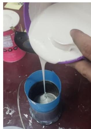
*Nota.* La primera imagen muestra cómo se pesa el material cerámico para equipararlo con el agua y la segunda imagen muestra el vertimiento de este sobre la tpm en el cubilete.
