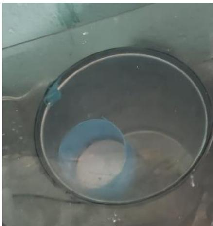
*Nota.* La imagen muestra al cubilete dentro de la cámara de vacío para eliminar todas las burbujas internas.
