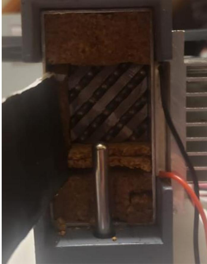
*Nota.* La imagen muestra, el intercambiador TPMS ubicado en el banco de pruebas a una inclinación de  $0^\circ$ .
