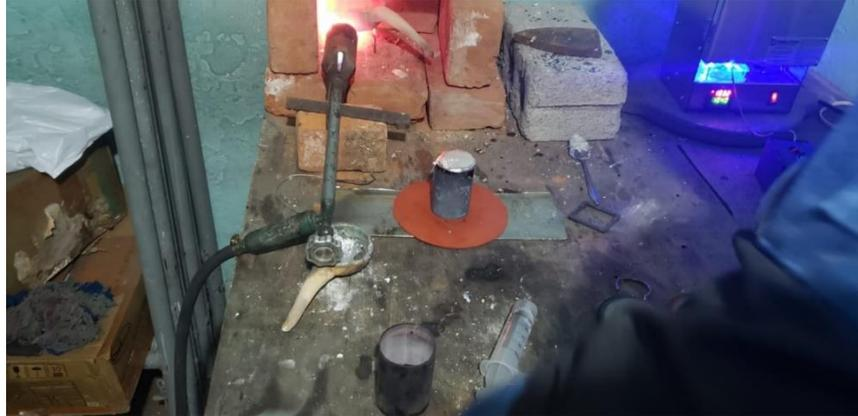
*Nota.* La imagen muestra el ingreso del aluminio al molde. Se puede observar como en la parte inferior de la sección tomate se encuentra el conducto del vacío haciendo presión de ingreso.
