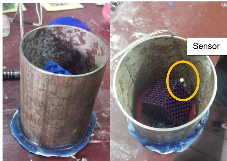
*Nota.* La imagen muestra cómo se adjunta la estructura TPMS en el cubilete y su inserción con cera y plastilina. El termopar está colocado tal como se indicó anteriormente.
