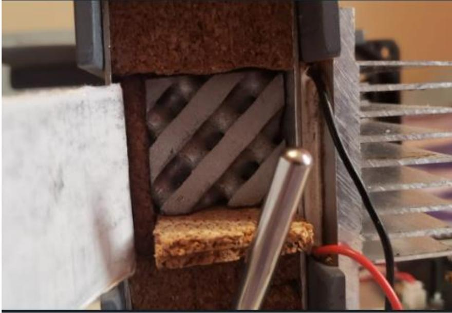
*Nota.* La imagen muestra, el intercambiador TPMS ubicado en el banco de pruebas a una inclinación de 45 °.
