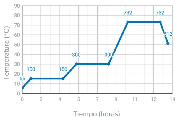
*Nota.* La figura muestra las fases a la cual debe ser programado el horno para realizar el quemado de la resina y la gráfica en plano cartesiano que muestra el proceso. Tomado de *Materiales Formlabs*. <https://formlabs.com/latam/3d-printers/form-3/>
