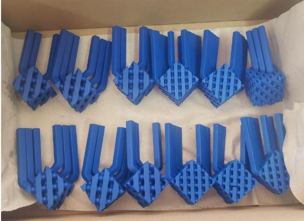
*Nota.* La imagen muestra varias de las estructuras a fundir con los distintos parámetros del DOE.
