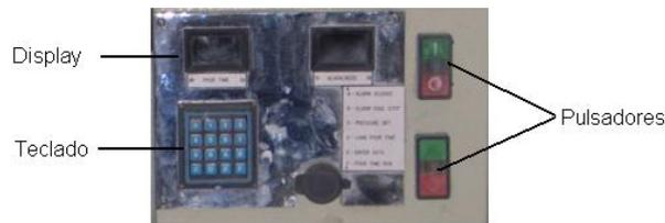
**Figura 5. 542.-** Apariencia de la caja de inyección.
