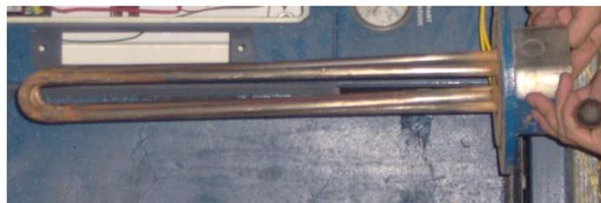
**Figura 4. 6.-** Apariencia física de las resistencias tubulares que componen el calentador.
