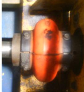
**Figura 5. 36.-** Acoplamiento montado, para los motores de 10 HP.
