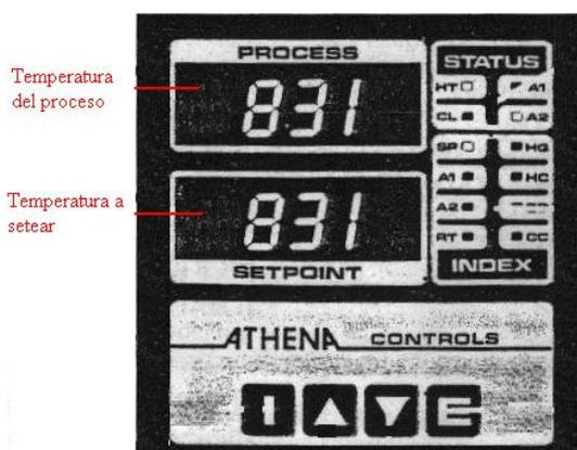
**Figura 4. 19.-** Apariencia física de controlador de temperatura ANTHENA:
