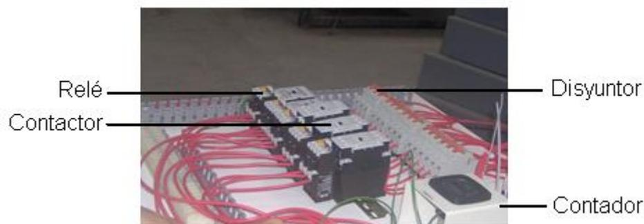
**Figura 5. 43.-** Montaje de los elementos en el tablero de control.
