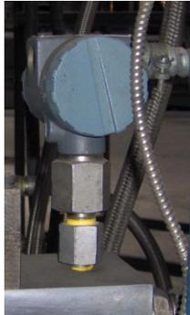
**Figura 5. 52.-** Apariencia del transductor montado en la máquina inyectora.
