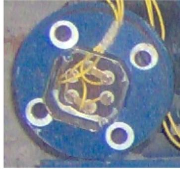
**Figura 4. 10.-** Conexión del calentador a 220V.
