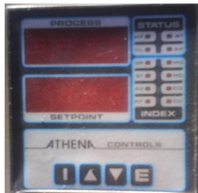
**Figura 4. 15.-** Aspecto externo de los controladores de temperatura.
