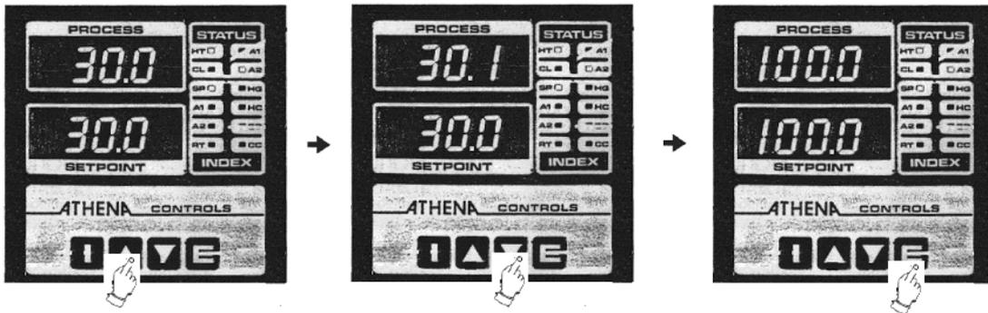
Figura 4. 21.- Ejemplo de seteo a un valor de temperatura de 100 °C
