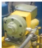
**Figura 2. 15.-** Motor neumático para los agitadores.
