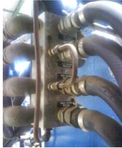
**Figura 5. 40.-** Apariencia del cabeza de inyección en lo que constituye la máquina inyectora.
