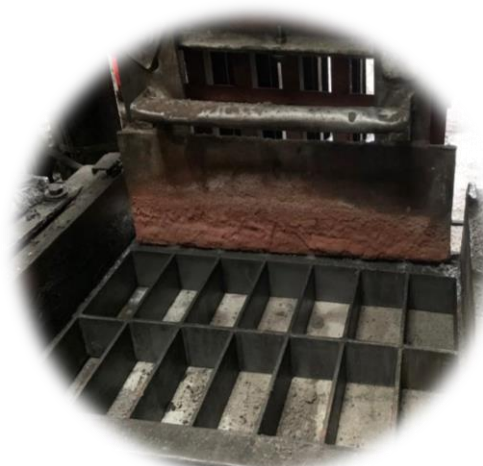
Compactación de Adoquines
