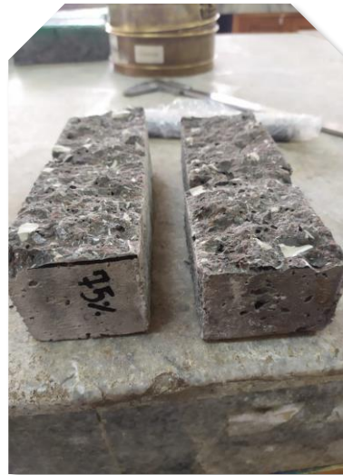
Elaboración de adoquines con residuos cerámicos triturados
