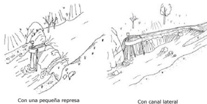
Figura 1.9 Tipos de instalación
