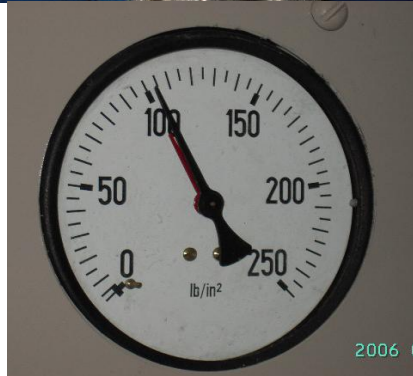
Figura 3.3.- Presión de entrada al banco de prueba, con un valor de 105 PSI
