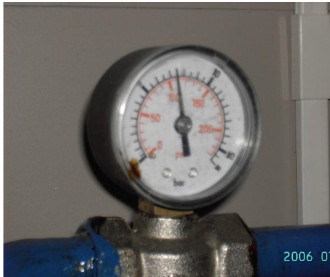
Figura 3.2.- Presión de entrada al banco de prueba, con un valor de 104 PSI
