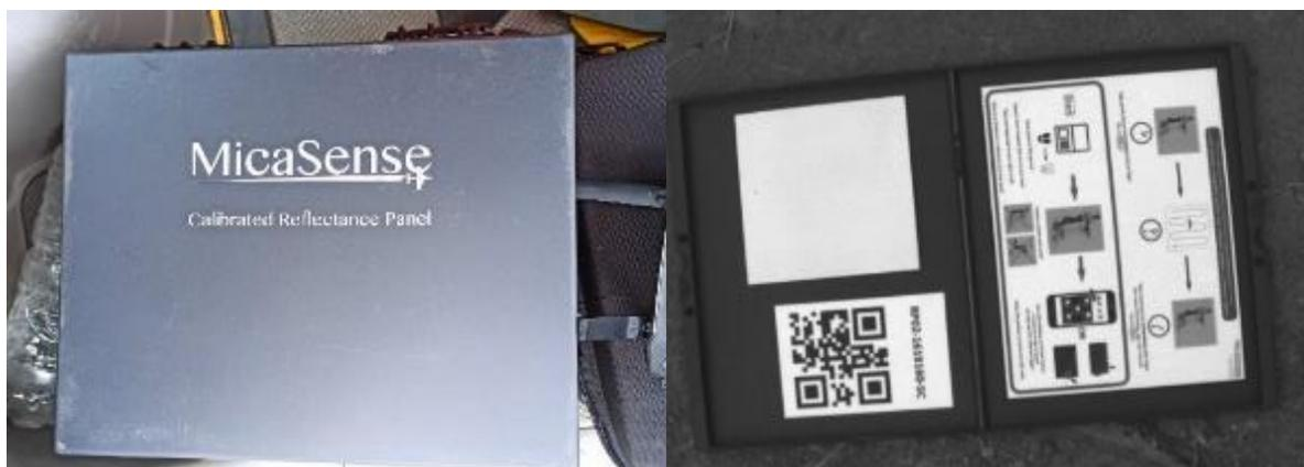
*Nota.* Diana de calibración usada para la corrección radiométrica de las imágenes obtenidas del UAV.
