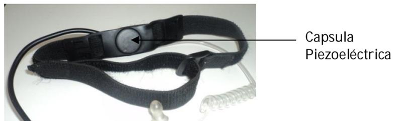
**Figura 2. 2 Cápsula piezoeléctrica correspondiente al laringófono..**
