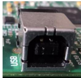
**Figura 3. 7 Puerto de comunicación entre el dispositivo y el computador.**
