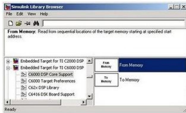
**Figura 1. 15 Bloques de extracción y guardar datos de la memoria del DSP**
