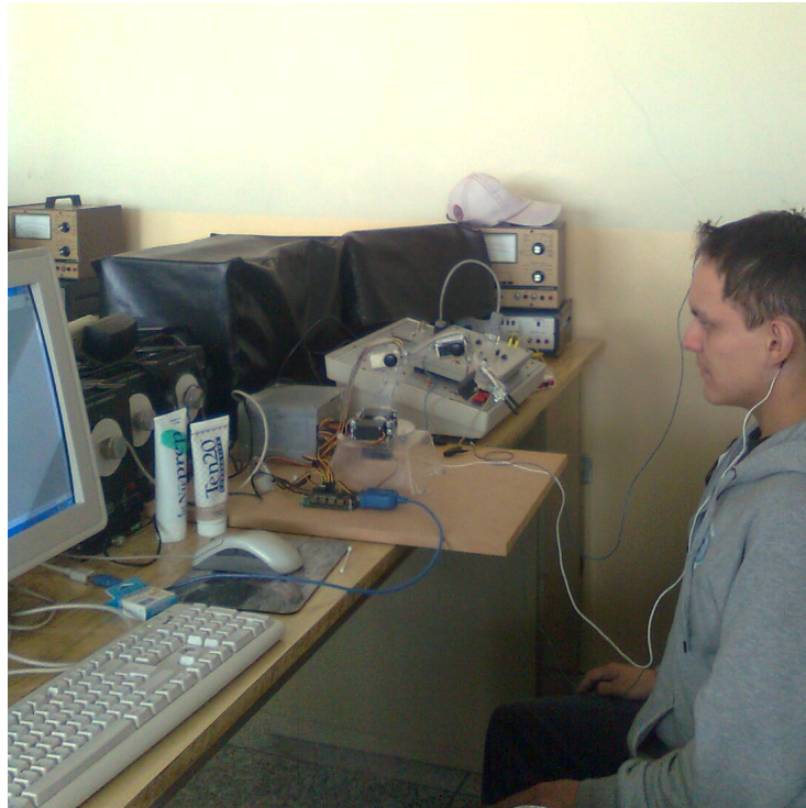
Figura 3.28: Implementación total del sistema para control de un brazo robótico mediante ondas generadas por actividad cerebral.
