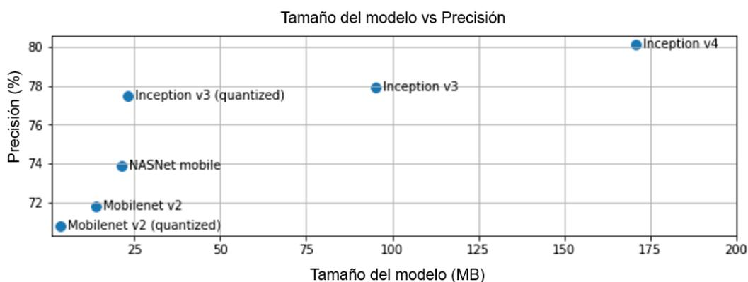
*Nota.* La figura presenta la comparación de la exactitud y el tamaño en MB de varios modelos de DL orientados para aplicaciones móviles. Tomado de (TensorFlow, 2021).
