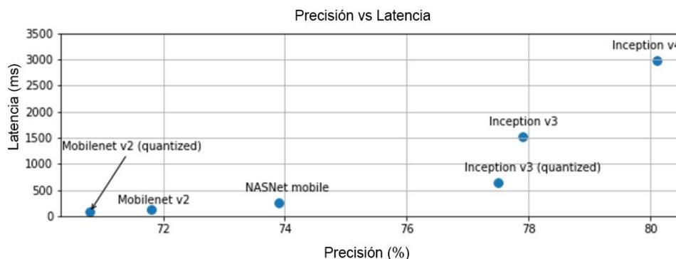
*Nota.* La figura presenta la comparación de la latencia en milisegundos y la exactitud de varios modelos de DL orientados para aplicaciones móviles. Tomado de (TensorFlow, 2021).
