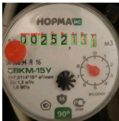
*Nota.* La figura muestra la detección de dígitos efectuada en una fotografía de un medidor de agua potable.
