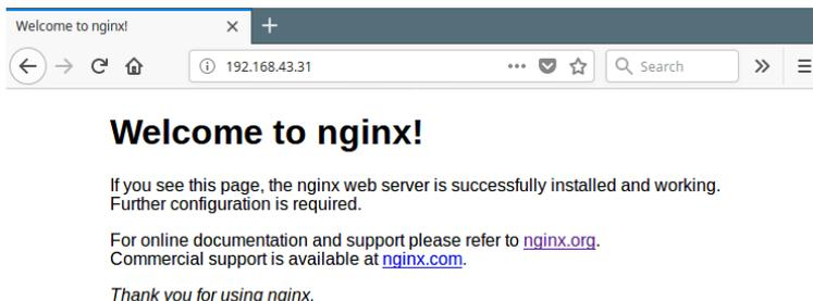
*Nota.* En esta captura se muestra la ventana de bienvenida de Nginx al ingresar al navegador con la IP 192.168.43.31 que es la dirección en dónde está el servidor local, después se subió este servidor en una máquina con una ip pública.
