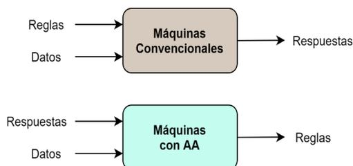
*Nota.* La figura muestra gráficamente las principales características que diferencian a una máquina convencional como un PC de una máquina con ML.
