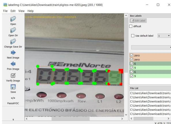
*Nota.* se muestra la aplicación *labellmg* con la selección etiquetada de las regiones en donde se encuentran los dígitos de un medidor de energía eléctrica, el resultado final de este etiquetado es un archivo plano *.txt* que se usa para el entrenamiento.
