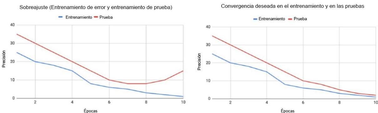
*Nota.* El gráfico de la izquierda muestra un punto de inflexión donde el error de validación comienza a aumentar a medida que la tasa de entrenamiento disminuye. En contraste, la gráfica de la derecha muestra un modelo con la relación deseada entre el entrenamiento y el error de prueba. Tomado de (Shorten & Khoshgoftar, 2019).
