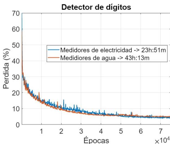
*Nota.* La figura presenta en la curva azul la pérdida para la detección de dígitos en medidores de energía eléctrica y en la curva naranja para medidores de agua.
