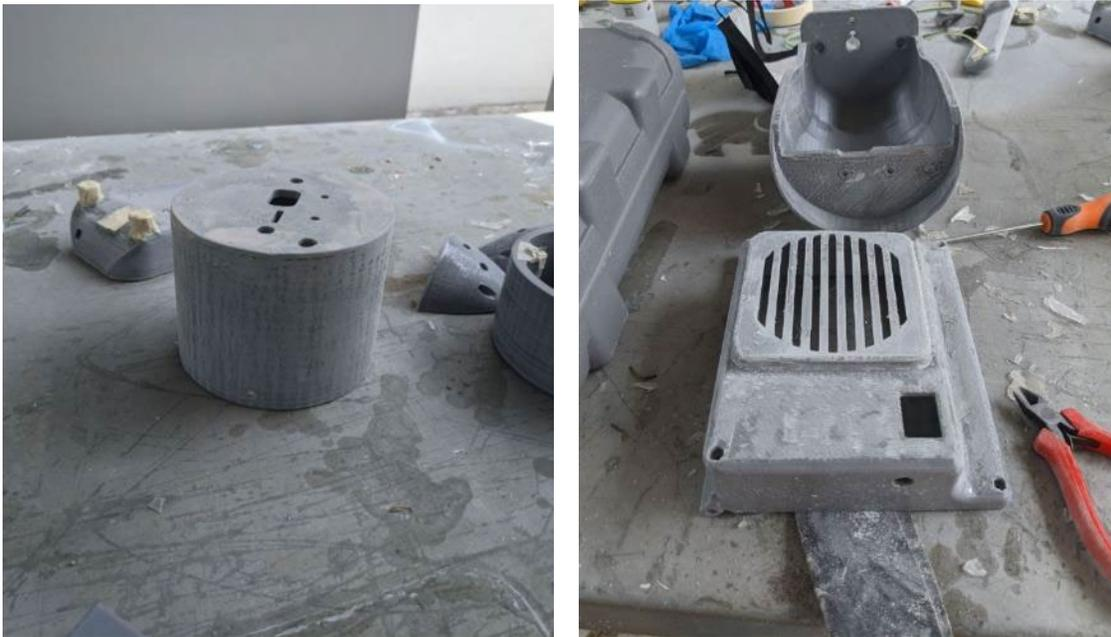
Finalmente, ya consolidados los anteriores procesos, con todo el material completamente seco y limpio, se procede a la pintura. El pintado se realiza en dos pasos, el primer paso consta de colocar imprimante, que aumenta la capacidad de adhesión de la pintura a la pieza plástica, este imprimante es de color gris y posee un espesor alto. Como segundo paso, la pintura es colocada de acuerdo con el color necesario para el usuario.
