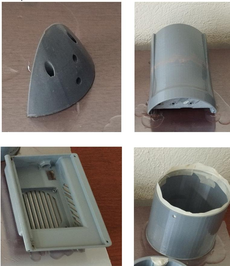
El paso siguiente es el lijado. A pesar de que la resina epoxi mejoró notablemente la calidad superficial, aún existen irregularidades y secciones con picos o valles que producen rugosidad. Así, para eliminar todas estas se realiza un lijado con hojas más finas, se utilizaron con grano 600 y 1000. Para este paso tampoco fueron utilizadas herramientas que giren a altas velocidades por el daño que pueden producir las altas temperaturas generadas por fricción.
