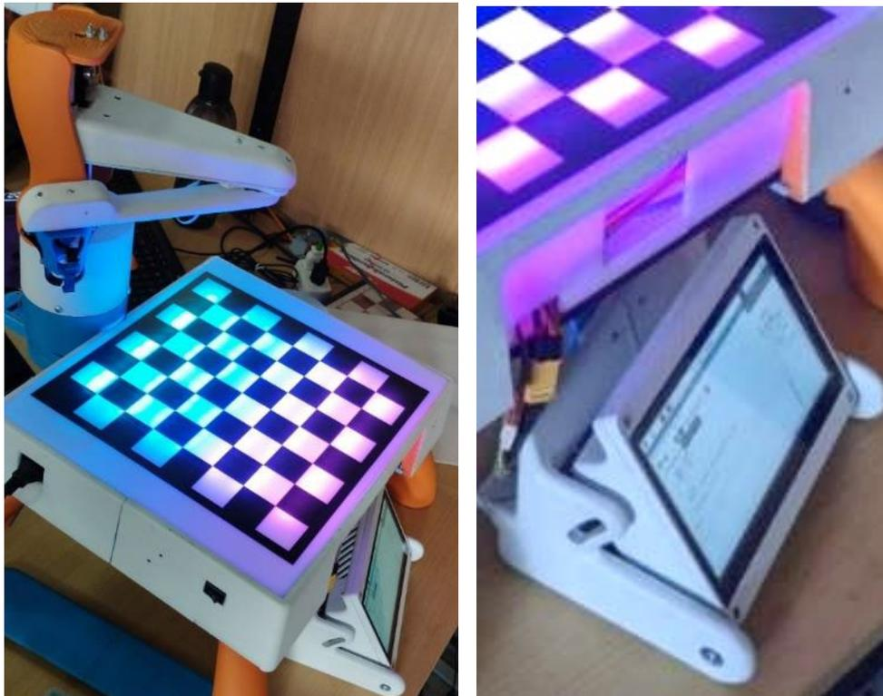
Finalmente, se colocan todas las piezas restantes. Ubicando las carcasas con modificaciones en los eslabones finales, con un movimiento correcto. La cámara y su iluminación fueron situadas en la parte superior del prototipo a una altura suficiente con respecto al tablero de ajedrez, esto con ayuda de un tubo de soporte, de tal manera que la visión artificial se efectúe correctamente.
