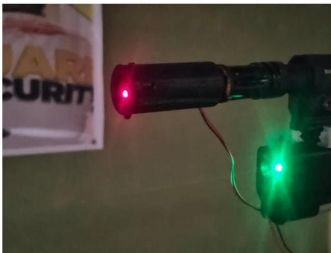
En el caso particular del escenario para pruebas y calibración, el láser de color rojo será empleado para posicionar y apuntar el fusil de manera automática a cada blanco objetivo, mientras que el láser de color verde corresponde al sistema láser acoplado al riel Picatinny del arma como se muestra en la **Figura 142**, dicho sistema será el que se emplee en lo demás escenarios durante la capacitación, y permitirá identificar los disparos realizados por el fusil.
