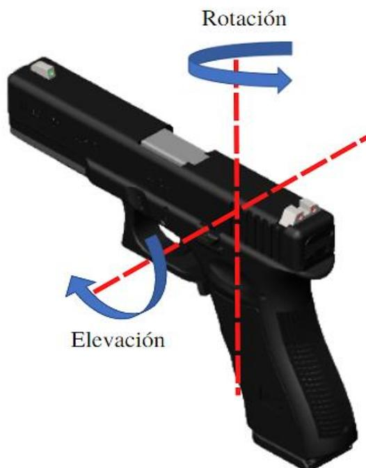
Como se aprecia en la **Figura 26**, el movimiento de rotación del arma se traducirá en un movimiento lineal del láser en el eje X sobre el plano de la imagen proyectada. En consecuencia, el movimiento de elevación se traducirá igualmente en un movimiento lineal, pero esta vez en el eje Y. Estos movimientos junto a la visión artificial permitirán alinear el arma sobre cualquier blanco mostrado sobre la superficie de proyección, como se aprecia en la **Figura 27**.
