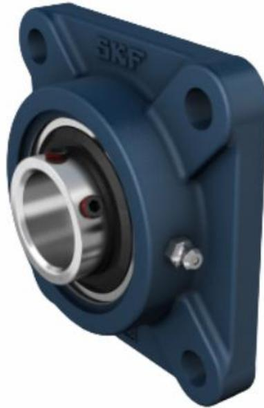
La chumacera UCF 208 **Figura 33**, tiene un rodamiento de inserción que posee una hilera de bolas en su interior, lo que le permite soportar cargas radiales y axiales moderadas, como se aprecia en la **Figura 34**. Se caracteriza por tener una construcción robusta y un diseño de fácil montaje, lo que los hace adecuados para una amplia variedad de aplicaciones industriales, desde maquinaria pesada hasta equipos de uso comercial.
