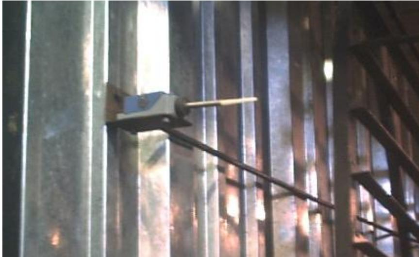
Figura 3.3 Detector final de carrera
