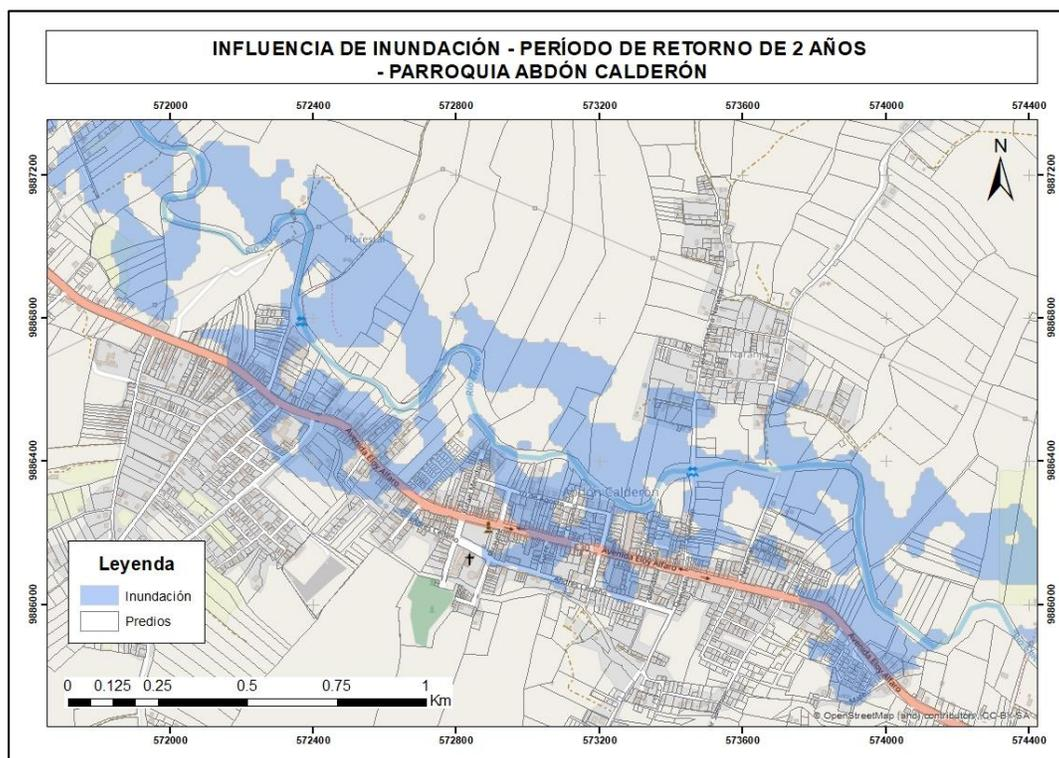
Es fundamental destacar que el mapeo de las zonas propensas a inundaciones es una herramienta importante para la gestión del riesgo de inundaciones. En este sentido, HEC-RAS, como modelo hidráulico, desempeñó un papel esencial al simular el comportamiento del río y las inundaciones en el área de estudio. Por lo tanto, se convierte en una herramienta indispensable para llevar a cabo el mapeo de las zonas susceptibles a inundaciones.
