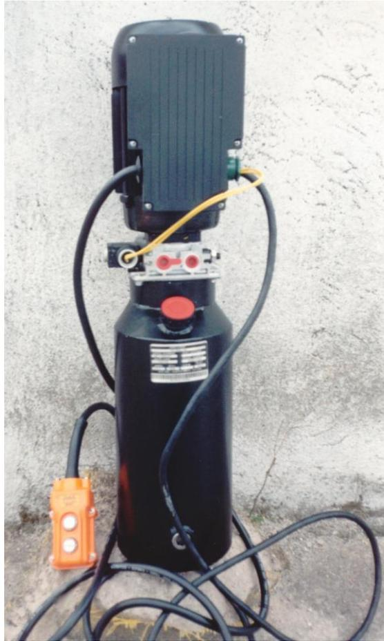
**Figura 2-50 Unidad compacta de potencia**
