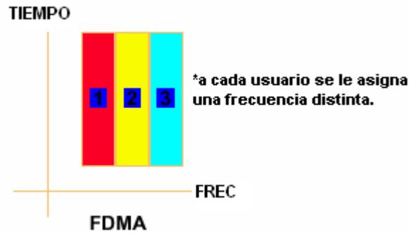
Figura. 1. 15. Multiplexación por división en frecuencia
