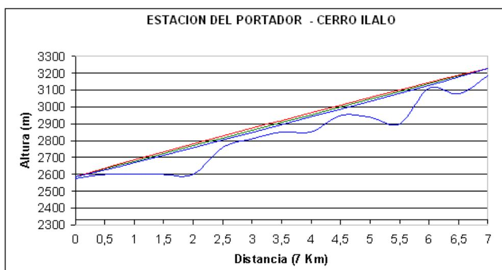
Figura. 5.8. Levantamiento de zona de Fresnel Enlace 1
