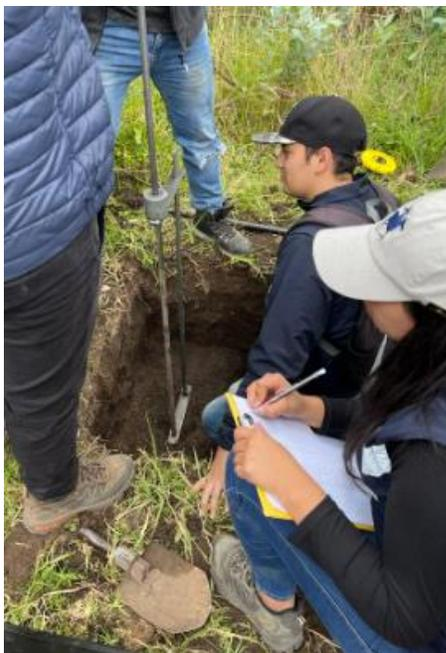
*Nota.* La excavación se realizó a 1.50 m para la identificación del tipo de suelo y la ejecución del ensayo DCP
