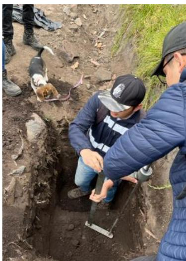
*Nota.* La excavación se realizó a 1.50 m para posteriormente tomar las muestras representativas
