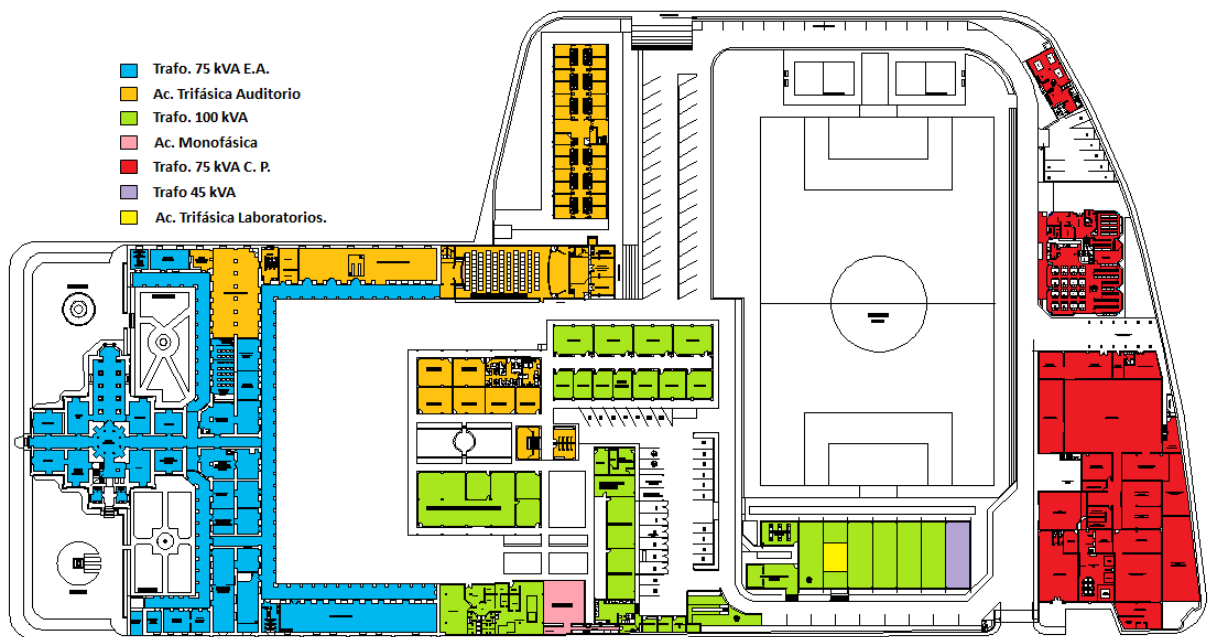
Figura 3.2 Distribución de cargas según las fuentes de alimentación a al ESPE-L.
