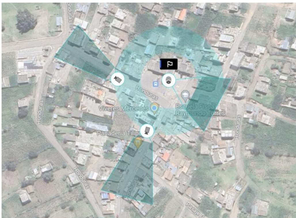
*Nota.* En la figura se puede observar la el punto de instalación de las cámaras y el alcance visual que tiene en el mapa del barrio Tilipulo.
