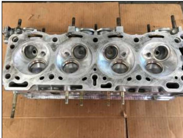
*Nota.* El gráfico muestra la de la culata del motor, rectificada.
