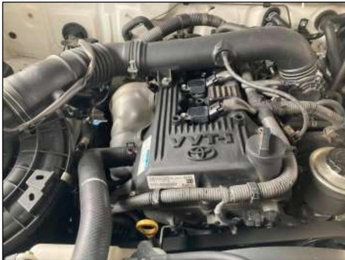
*Nota.* El gráfico muestra el retiro de componentes exteriores del motor Toyota 2TR.
