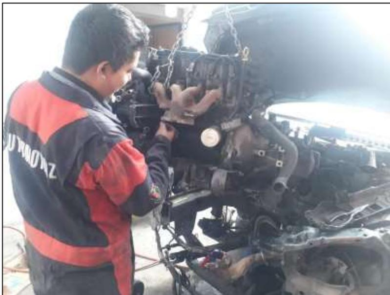
*Nota.* El gráfico muestra el desmontaje de un motor de combustión interna de un vehículo, en el cual se visualiza los elementos fijos de dicho motor Tomado de: (Chávez et al., 2021).
