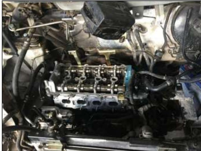
*Nota.* El gráfico muestra el retiro de componentes internos del motor Toyota 2TR.
