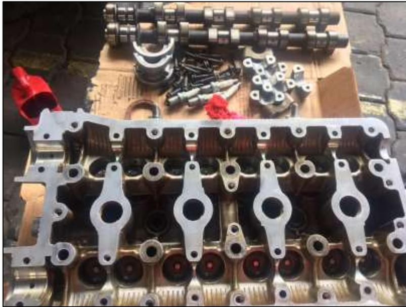
*Nota.* El gráfico muestra los elementos sustituidos en la rectificación del motor.
