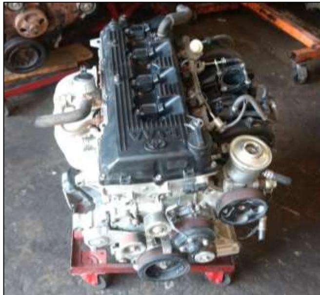
*Nota.* El gráfico muestra el motor desmontado ya de la camioneta, listo para ser desarmado y rectificado.
