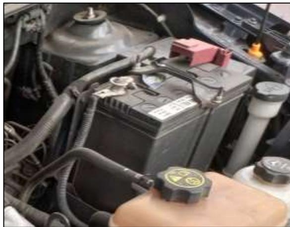
*Nota.* El gráfico muestra la desconexión de la batería, previo al desmontaje del motor.
