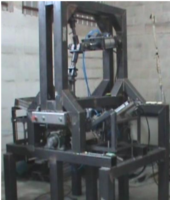
Figura 3.1. Máquina estampadora de jabón
