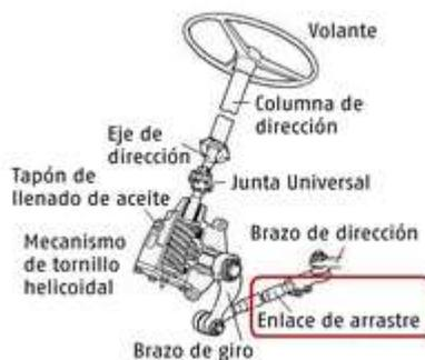
*Nota.* En la imagen se observa la columna de dirección del volante de un automóvil eléctrico. Tomado de (Narváez, 2021).
