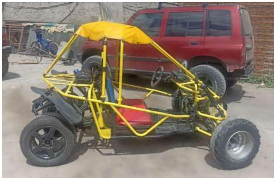
La imagen anterior ejemplifica la estructura final del vehículo construido, donde se observan claramente las ruedas, estructura metálica externa, la dirección construida, así como el sistema de frenos y suspensión elaborado para que el automóvil posea una resistencia adecuada para que soporte el trayecto durante la ruta enviada.
