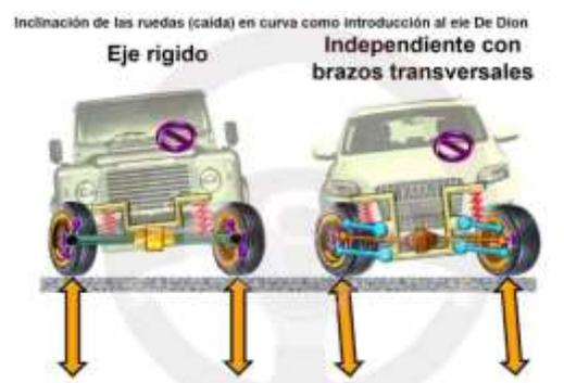
*Nota.* La imagen demuestra el funcionamiento de la suspensión rígida o independiente en un
