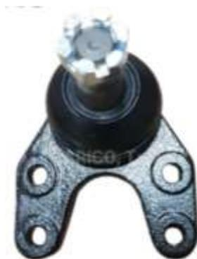
*Nota.* En la imagen se observa la composición de la rótula y las varillas del sistema de suspensión. Tomado de (Torres, et al., 2021).
