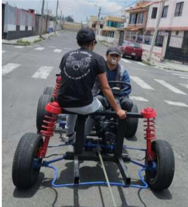
En las pruebas de desempeño utilizadas, se tiene en cuenta si la suspensión funciona en conjunto con la dirección al girar a la izquierda y a la derecha, porque uno de los principales errores que comete el sistema de suspensión es que la suspensión no funciona, porque el automóvil se puede mover a el lado sin usar una rueda de accionamiento, en cuyo caso es probable que se dañen las rótulas o las puntas.
