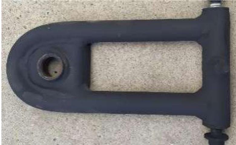
En la siguiente imagen se observa la mesa de suspensión de la parte delantera con sus respectivos bujes para que la misma se enganchada al vehículo cuando se dé su construcción completa.
