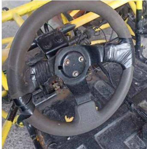
Seguido, se instala la barra de dirección directamente con el volante para que el encuadre sea como necesita el chofer para una nueva forma de dirección.
