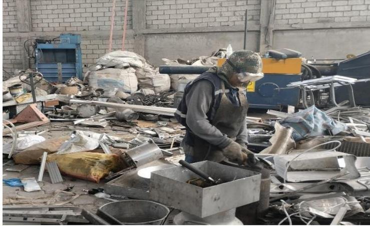
*Nota.* En el área de corte se evidencia que la planta de un orden en el espacio de trabajo, trae consigo la acumulación de polvos y partículas metálicas, derivados del proceso de corte.
