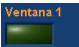
Sensor cerrado – indicador apagado (Ventana cerrada)
