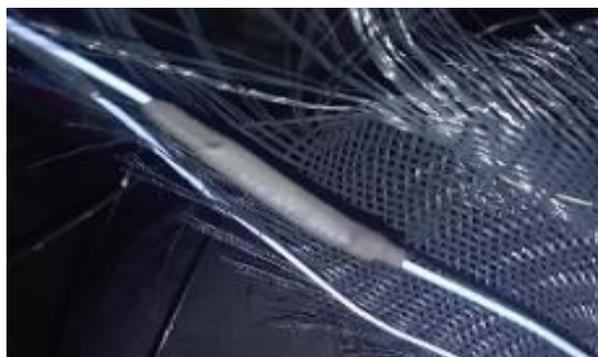
*Nota.* El tubo termo encogible es aplicado con el calor para que se adopten sobre todo el entorno del cableado reparado permite proteger y aislar conexiones de cables, terminales que puedan provocar corto circuito y componentes que se pueda permitir y cubrir, aislar.
