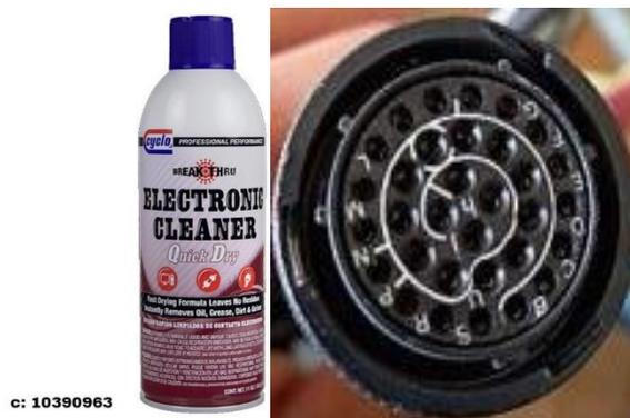
*Nota,* Se detectó impurezas de como polvo por lo que se realizó una limpieza de acuerdo a la AC43 13 1b para el proceso de limpieza.
