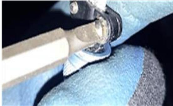
*Nota.* Desinstalación de forma correcta los conectores dañados o en malas condiciones utilizando las herramientas adecuadas a la tarea.
