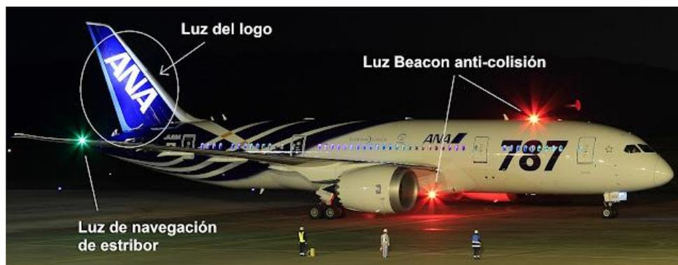
*Nota.* Luces en operación en vuelo y tierra (encendidas) de la aeronave. Tomado de (Oñate, 2019.)
