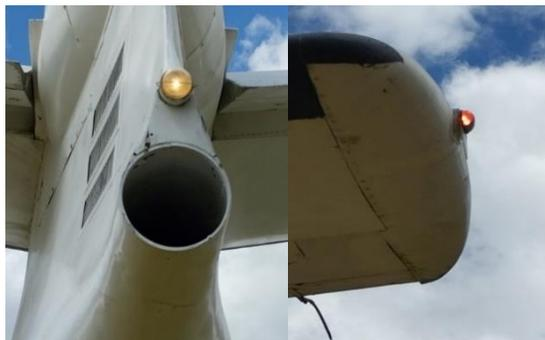
*Nota.* Se energizó primer instancia la aeronave para verificar funcionamiento correcto de la luz de posición de la aeronave Fairchild
