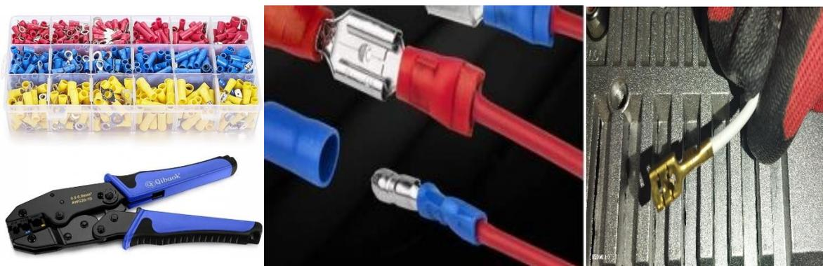
*Nota.* Remachado de los terminales según sus respectivos cables. Tomado de (Remachadora, herramientas, aeronáuticas).
