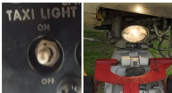
Se realizó la respectiva conexión y se hizo al proceso de funcionamiento mediante el encendido de las luces de rodaje de la aeronave Fairchild según sus respectivas documentaciones técnicas dando a concluir su correcta operación.
