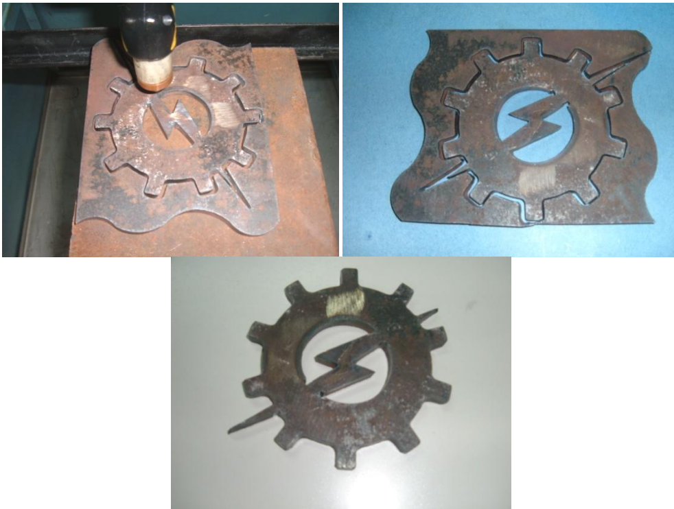
Figura 4.25 Resultados obtenidos con el sistema automático de corte
