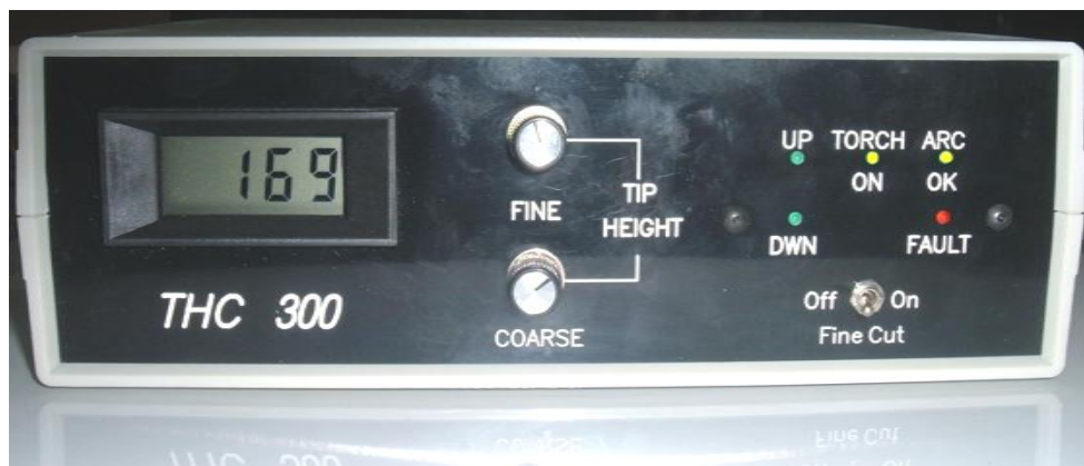
Figura 4.15 Encendido del led de arco transferido
