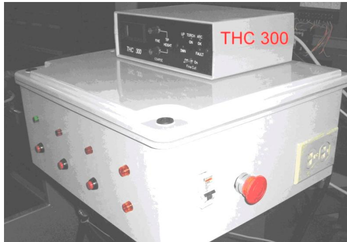
Figura 4.9 Caja de Control, parte externa
