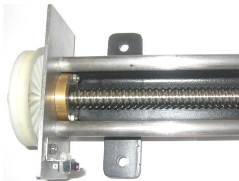
Figura 2.16 Flechas o ejes guías de la estructura horizontal coordenada “x”
