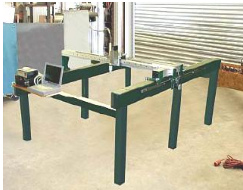
Figura 2.2 Mesa de corte por plasma de alta precisión.
