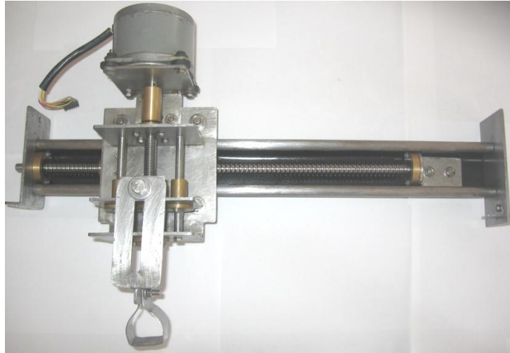
Figura 2.11 Estructura Horizontal, desplazamiento en la coordenada “y”
