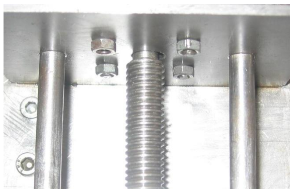
Figura 2.7 Flechas o ejes guías de la estructura vertical
