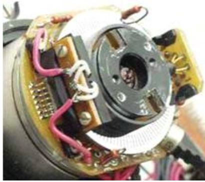
Figura 1.19 Motor de corriente continua con encoder de ranuras
