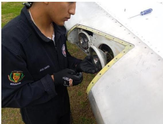
Nota. El gráfico representa a la inspección de luces externas usando el equipo de seguridad.
