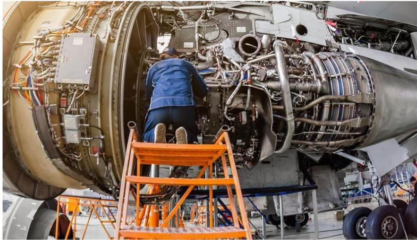
*Nota.* El gráfico representa al técnico aeronáutico realizando un respectivo mantenimiento a una turbina. Tomado de (TMAS, s.f.).
