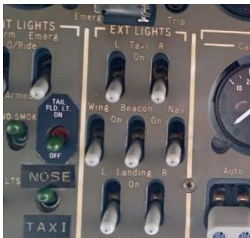
Nota. El gráfico representa al panel de control de luces de la aeronave en estudio, donde se encuentran específicamente el control de power/off las luces externas.
