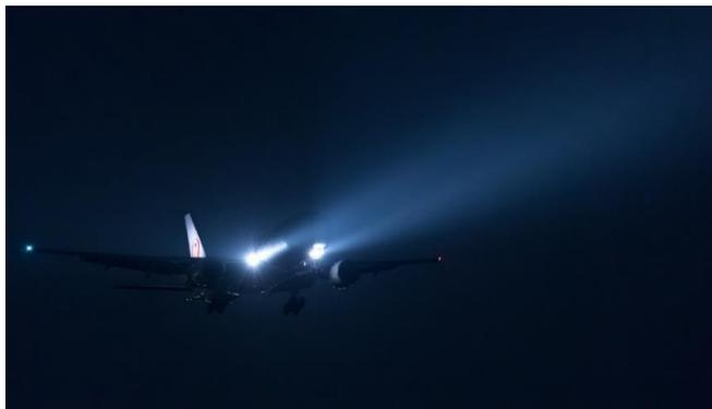
*Nota.* El gráfico representa a las luces externas landing, que se visualizan en los laterales de la aeronave. Tomado de (*Piloto, 2021*).
