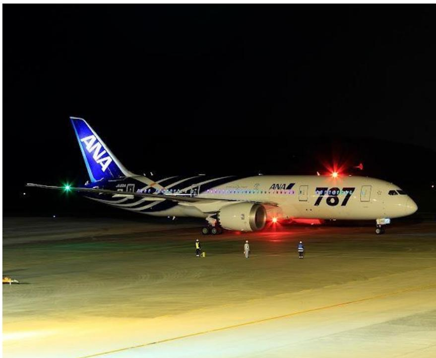
*Nota.* El gráfico representa las luces externas de anticolidión, que se visualizan de color rojo en la parte superior e inferior de la aeronave. Tomado de (*aviones, 2016*).
