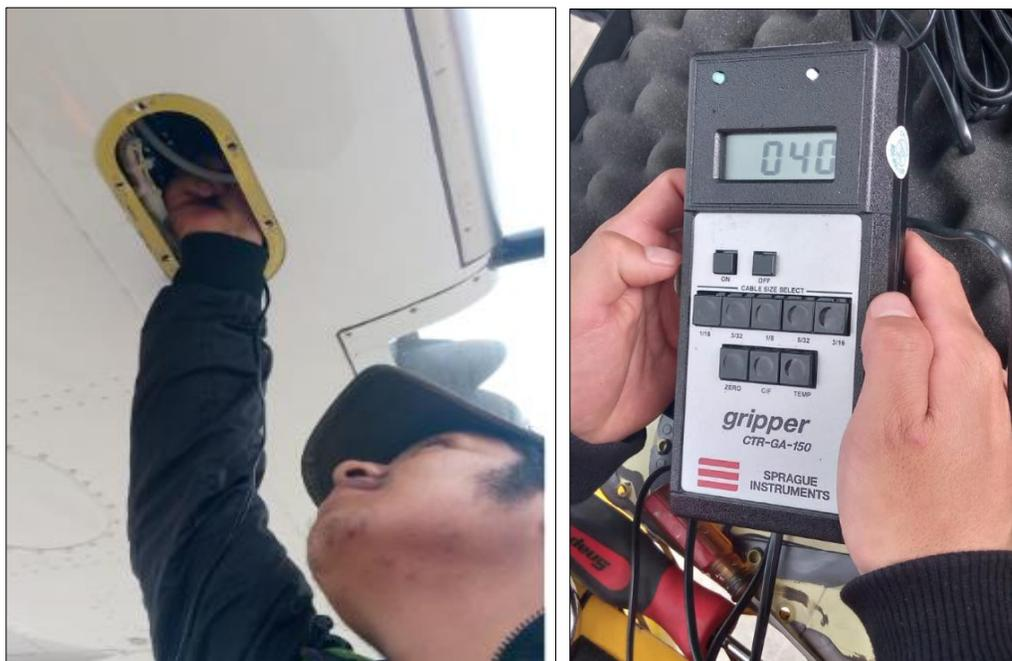
Una vez revisada la tensión de los cables, se procedió a poner la cabrilla en posición neutral utilizando un seguro el mismo que se debe instalar en la columna de la cabrilla como muestra la Figura 48.
