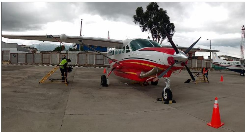
Luego se realizó la respectiva inspección de la aeronave, para saber en qué condiciones se encontraban, especialmente de los alerones y elevadores ya que en esos componentes se centrará la inspección de 400 horas. Dicha inspección visual resultó satisfactoria, como muestra la Figura 43.
