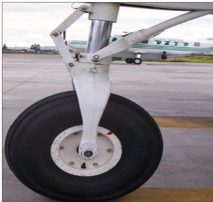
Las cargas verticales que se producen durante el aterrizaje o el rodaje son absorbidas por el brazo de arrastre y el amortiguador del tren. El tren de nariz puede dirigirse (timonearse) hacia ambos lados en un arco de 15 grados utilizando los pedales del timón y hasta 56 grados utilizando los pedales junto con la aplicación del freno diferencial (The Mind Aviation Training, n.d.).
