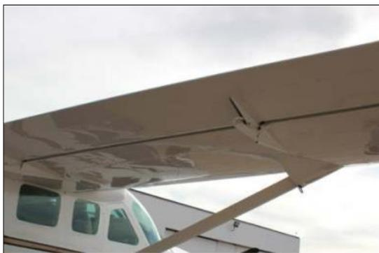
Los flaps del ala son de gran envergadura, de una sola ranura y están accionados por un motor eléctrico. El sistema está protegido por el disyuntor FLAP MOTOR del panel CB.
