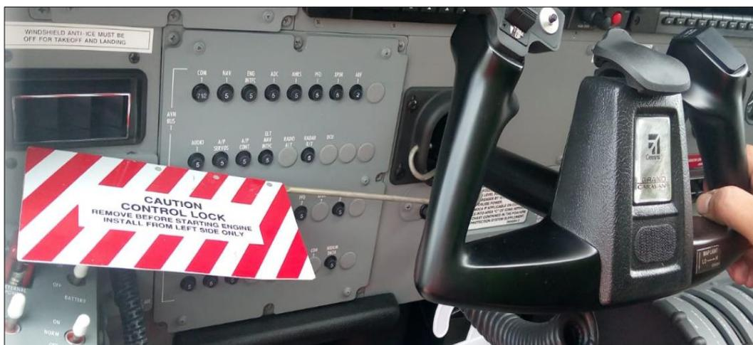
Una vez asegurada la cabrilla en posición neutral, se procedió a instalar el digital protector, esta es una herramienta que nos permite comprobar los grados que se mueven los alerones. Ya instalado la herramienta se movió la cabrilla a la derecha y a la izquierda completamente y se verificó los siguientes parámetros, dando como satisfactorio el chequeo como muestra en la Figura 48.
