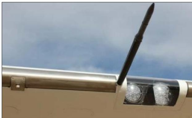
Controles e Indicaciones La veleta en el ala detecta el cambio en el flujo de aire sobre el ala y acciona la bocina de aviso a velocidades del aire de entre 5 y 10 nudos por encima de la pérdida en todas las configuraciones. Funcionamiento Compruebe el sistema de aviso de pérdida durante la inspección pre-vuelo poniendo momentáneamente en ON el interruptor de la BATERÍA y accionando la aleta del ala. El sistema está operativo si la bocina de aviso suena al empujar la aleta hacia arriba.
