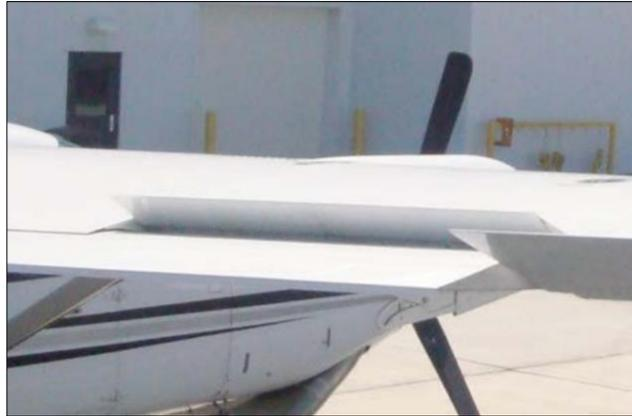
Los alerones están interconectados con el sistema de alerones a través de una varilla de empuje, a un brazo de la campana del alerón. Mientras que el movimiento de los alerones comienza simultáneamente con el recorrido ascendente del alerón, el movimiento de los alerones durante los primeros 5° del recorrido del alerón es insignificante.
