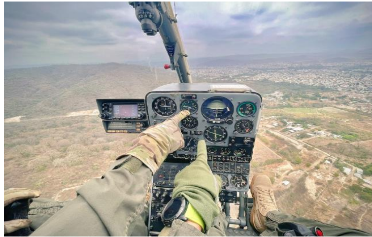
Cabina de vuelo e instrumentos del helicóptero Gazelle SA 341L
