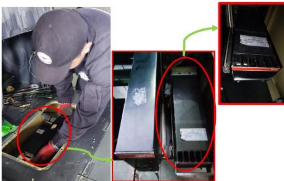
*Nota.* Instalación y conexión del transceiver VHF 20B en la montura, después de haber limpiado sus conectores con isopropanol.
