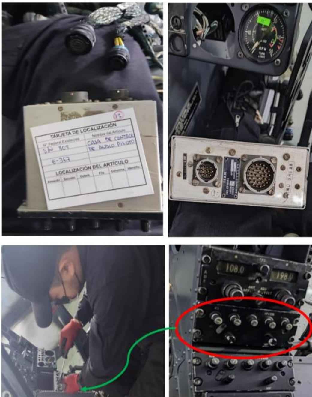
*Nota.* Instalación y conexión del equipo de control de audio del piloto, el ajuste del equipo se realizó por medio de los 4 cierres DZUS de ¼ de giro.
