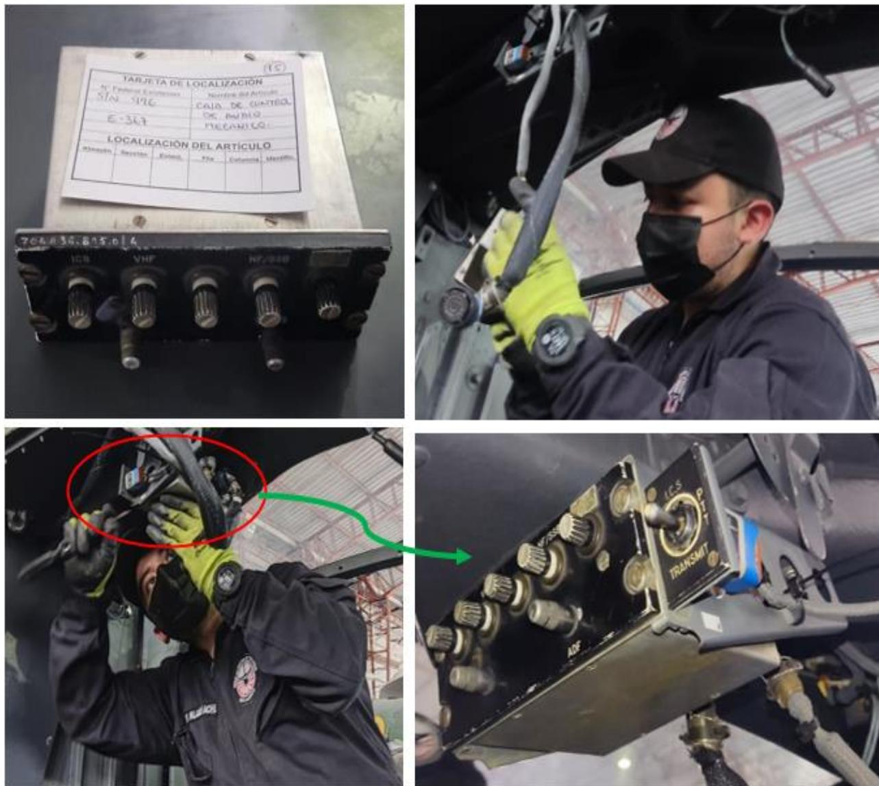
*Nota.* Conexión del equipo de control de audio del mecánico e instalación y ajuste del equipo por medio de los 4 cierres DZUS de ¼ de giro.
