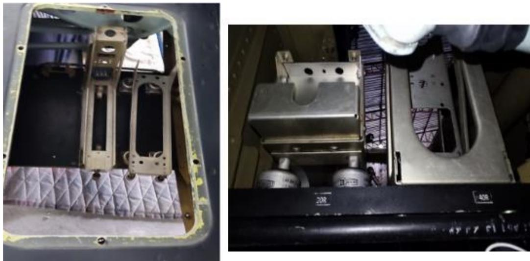
*Nota.* Colocación del soporte del equipo Transceiver VHF 20B
