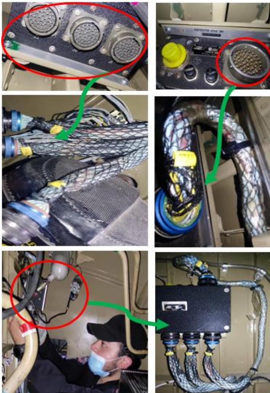
*Nota. Instalación y conexión de la caja de conexiones de intercomunicación*
