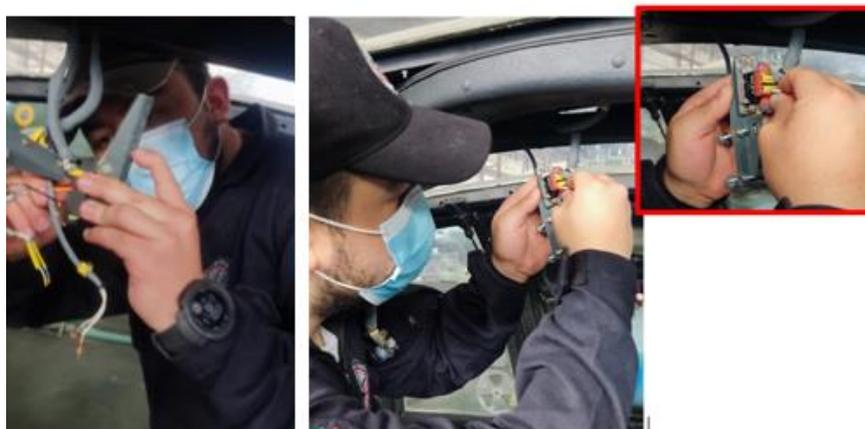
*Nota.* Extracción de los contactos de los módulos 4ΔR y 5ΔR
