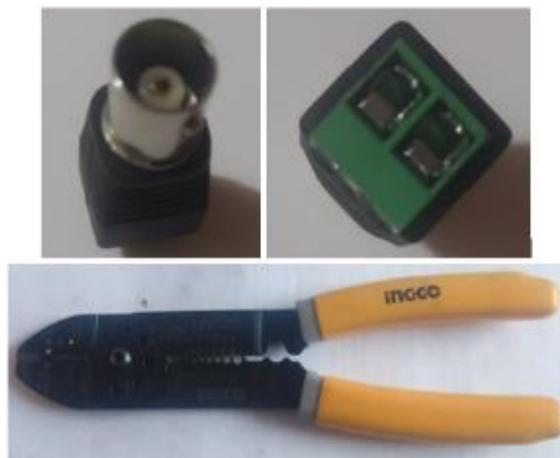
*Nota.* Cortadora de cables y conector coaxial bnc empleado para la reparación.
