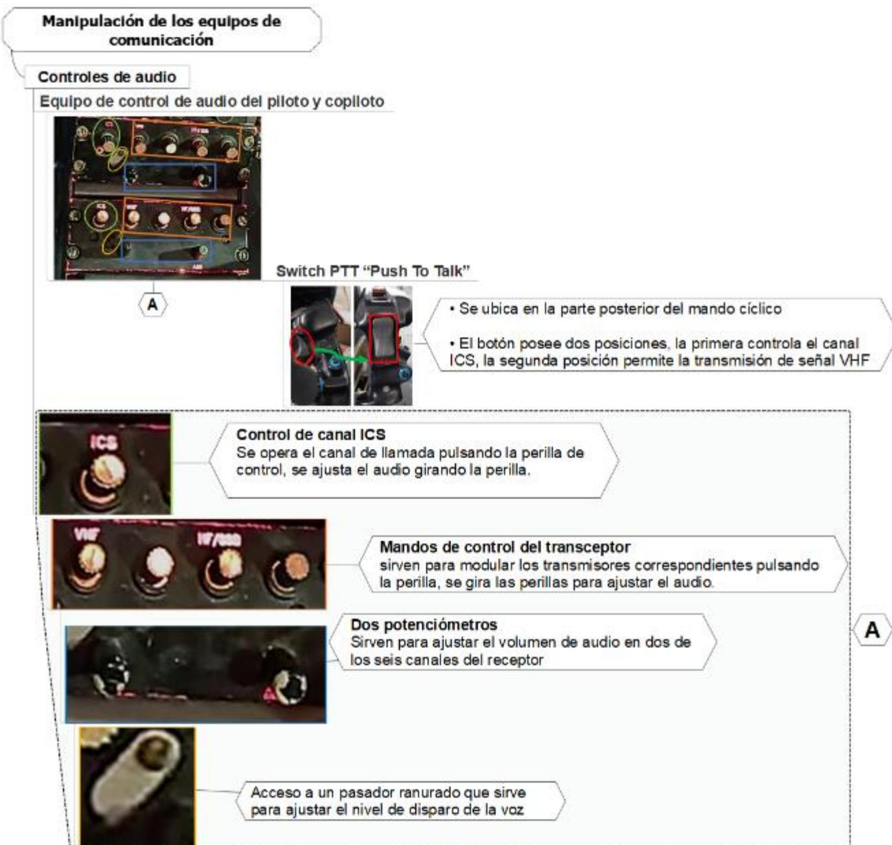
Nota. Esquema de descripción de los controles de los equipos de comunicación.
