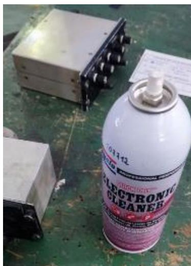
*Nota.* Aplicación de isopropanol en los equipos de control y control de audio.
