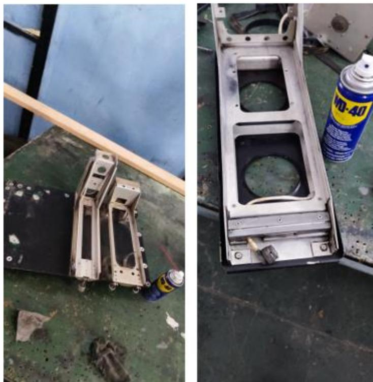
*Nota.* Empleo del producto WD-40 como tratamiento anticorrosivo en la superficie metálica de los soportes.
