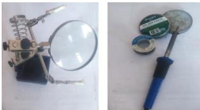
*Nota.* Soporte de soldadura con lente de aumento, herramientas soldadura.
