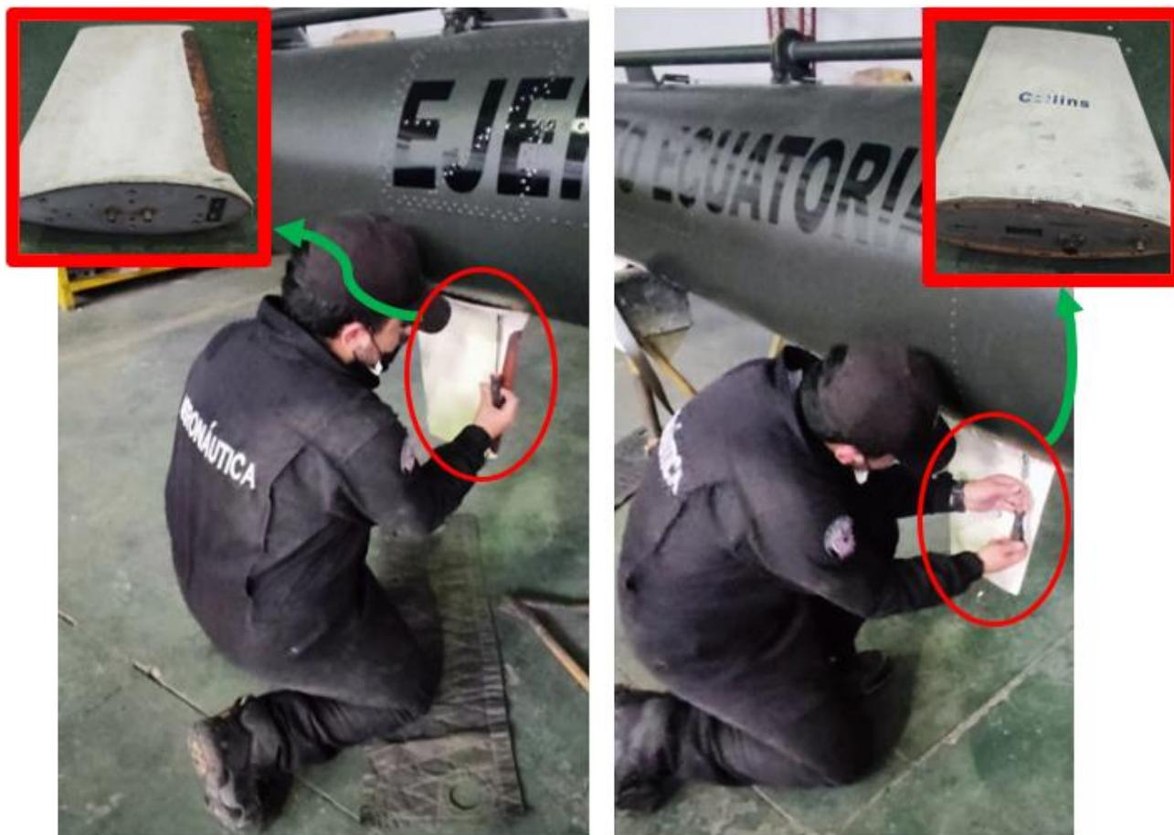
*Nota.* Instalación y conexión de las antenas de comunicación.
