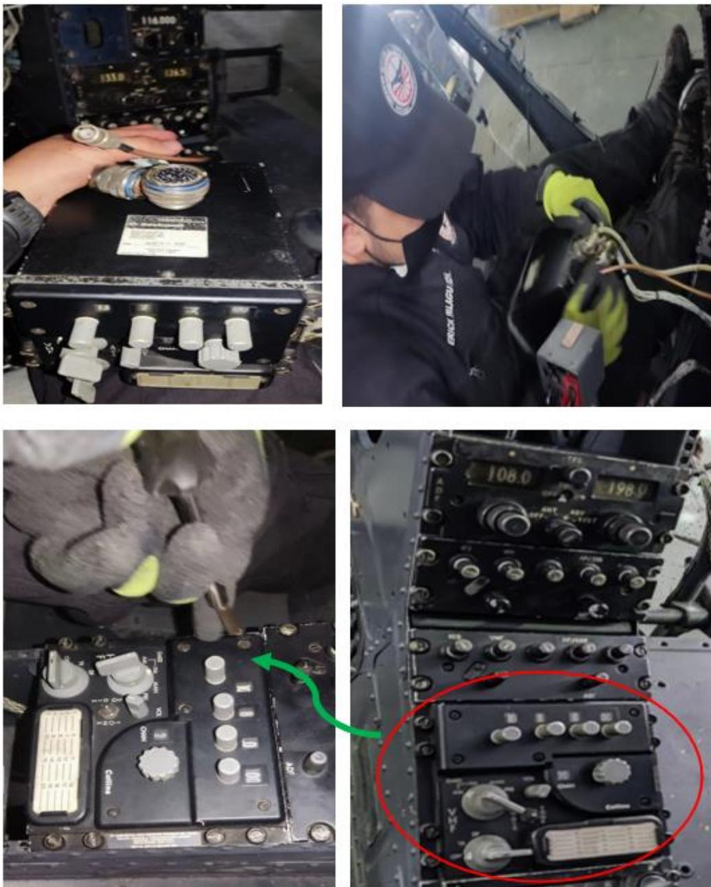
*Nota.* Conexión del equipo transceiver VHF186 (V) e instalación y ajuste del equipo por medio de los 8 cierres DZUS de ¼ de giro.
